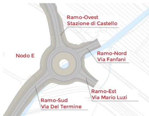
Figura 8-17 - Planimetria rotatoria NODO E
