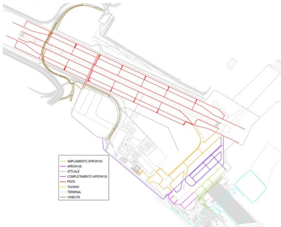
Figura 10-11. Rete di drenaggio per il sedime aeroportuale
