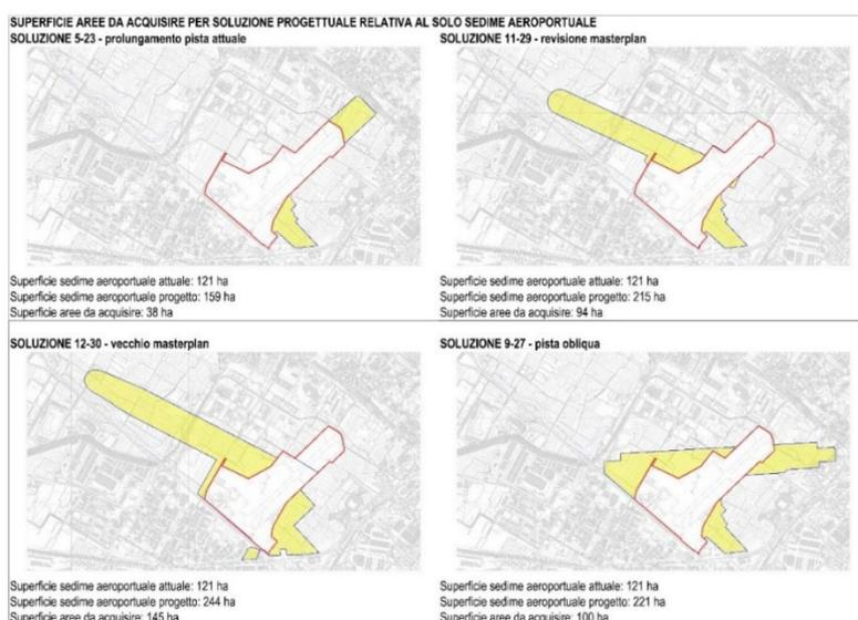
Figura 7-1 - Aree da acquisire (in giallo) rispetto al sedime aeroportuale attuale, nelle varie alternative analizzate
