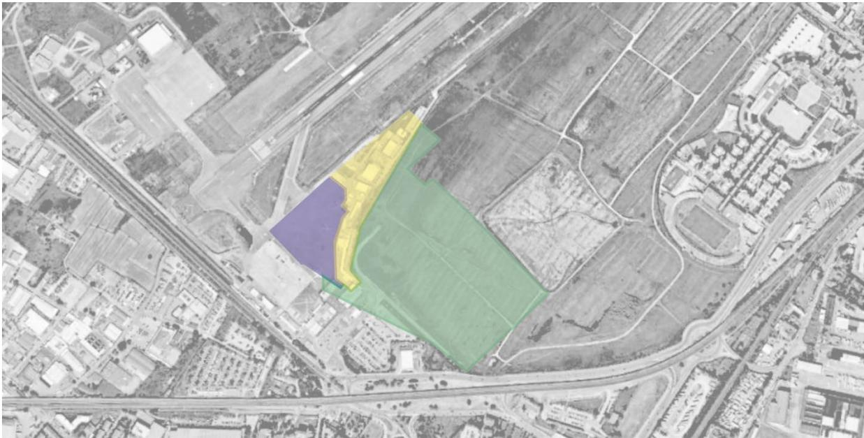
Figura 8-1 – Le zone di intervento. In verde l'area di realizzazione del terminal; negli altri colori gli interventi di adeguamento e ampliamento dell'attuale apron est
