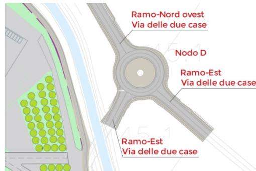
Figura 8-16 - Planimetria rotatoria Nodo D
