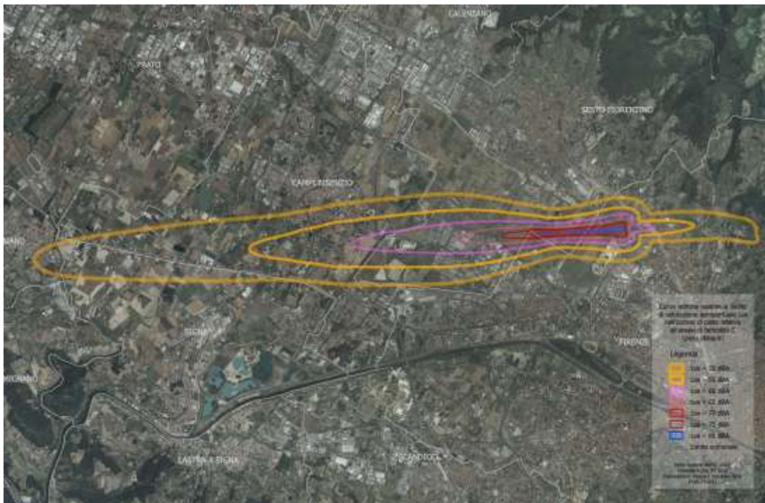
Figura 70 – Pista obliqua 09/27, 45.000 movimenti/anno. Curve isofoniche riferite allo scenario di utilizzo monodirezionale (Fonte: elaborazioni ARPAT poste a supporto del Rapporto Ambientale di cui all'Integrazione al PIT per la qualificazione dell'aeroporto di Firenze).
