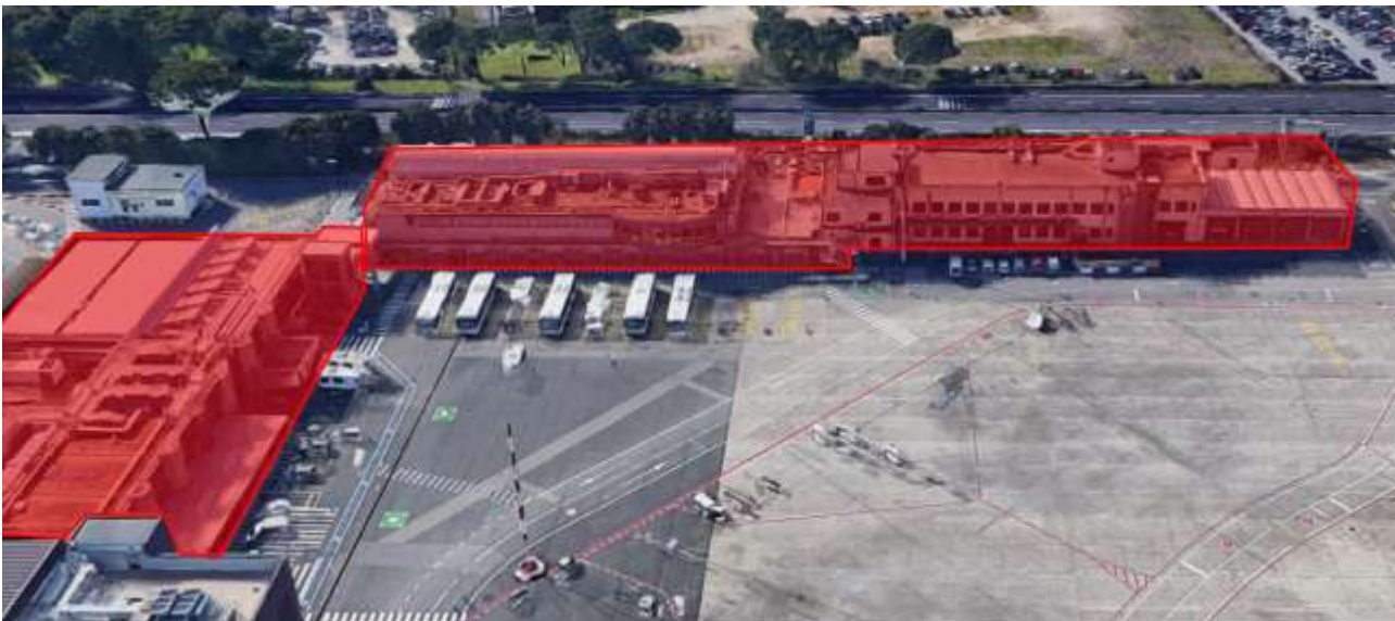
Figura 95 – Identificazione volumi oggetto di demolizione e ricostruzione
