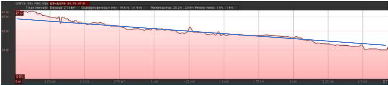
Figura 30 – Schematizzazione dell’altimetria dell’esistente piano di campagna in direzione longitudinale rispetto alla pista “obliqua” (contorno rosso) e suo possibile asse di progetto (contorno blu)
