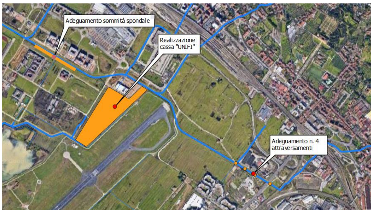
Figura 5-2 – Canale di Cinta Orientale – Interventi di progetto previsti nel Masterplan Aeroportuale e nel PUE di Castello
