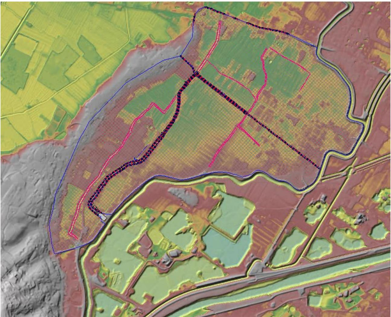
Figura 5-16: Vista del modello idraulico del Fosso Il Piano implementato sul software HEC-RAS.
