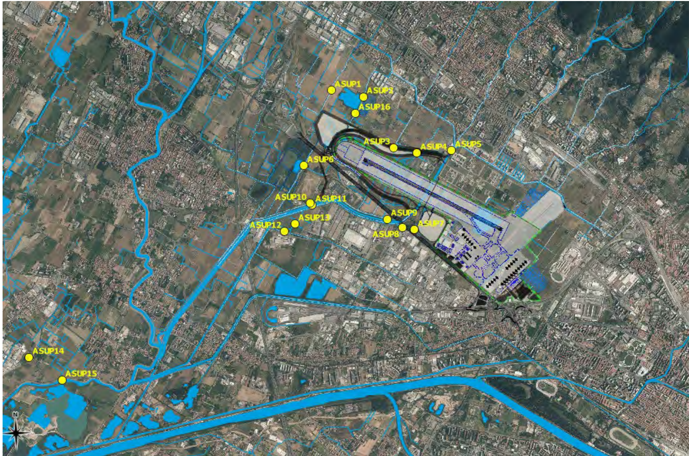
Figura 6: Planimetria area d'intervento e ubicazione delle stazioni di indagine delle acque superficiali.
