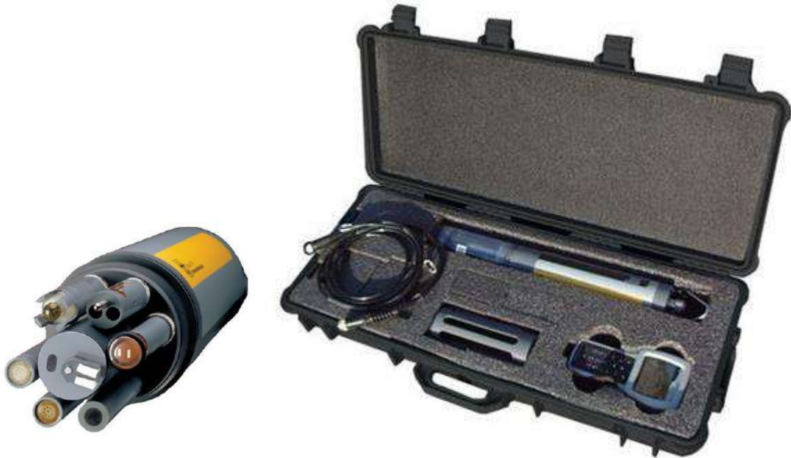
Figura 29: sonda multiparametrica con pc palmare utilizzata per le misure dei macroparametri in campo - YSI Inc. 650 MDS + 9820 V2-1
