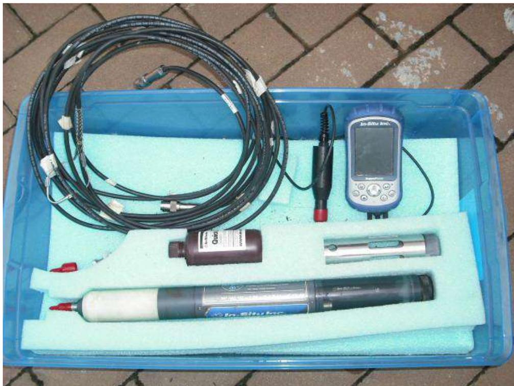
Figura 22: sonda multiparametrica con pc palmare utilizzata per le misure dei macroparametri in campo - Level Troll 9500 della ditta In-Situ Inc.
