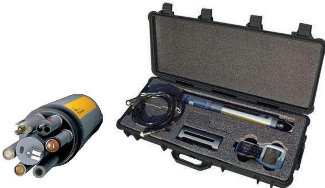
Figura 23: sonda multiparametrica con pc palmare utilizzata per le misure dei macroparametri in campo - YSI Inc. 650 MDS + 9820 V2-1
