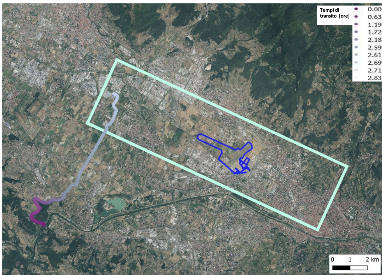
Figura 48 rappresentazione dei tempi di transito per il torrente VINGONE per una portata di deflusso pari a 20 m 3 /s.
