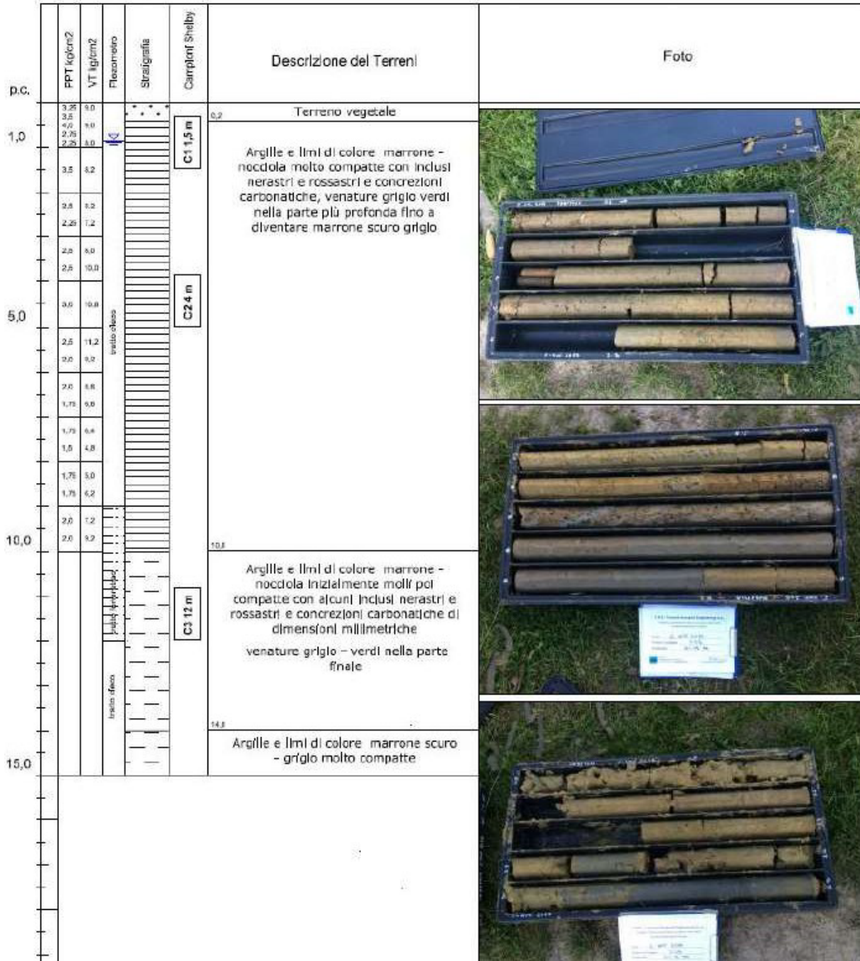
Figura 26 - Stratigrafia del sondaggio S05 realizzato durante la campagna geognostica presso l'area di progetto (in arancione in Figura 22)
