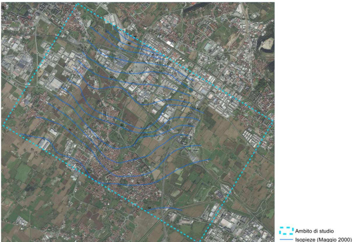
**Figura 6-18 Carta delle isopieze – quadrante nord-ovest (Fonte: Piano strutturale del Comune di Campi Bisenzio)**
