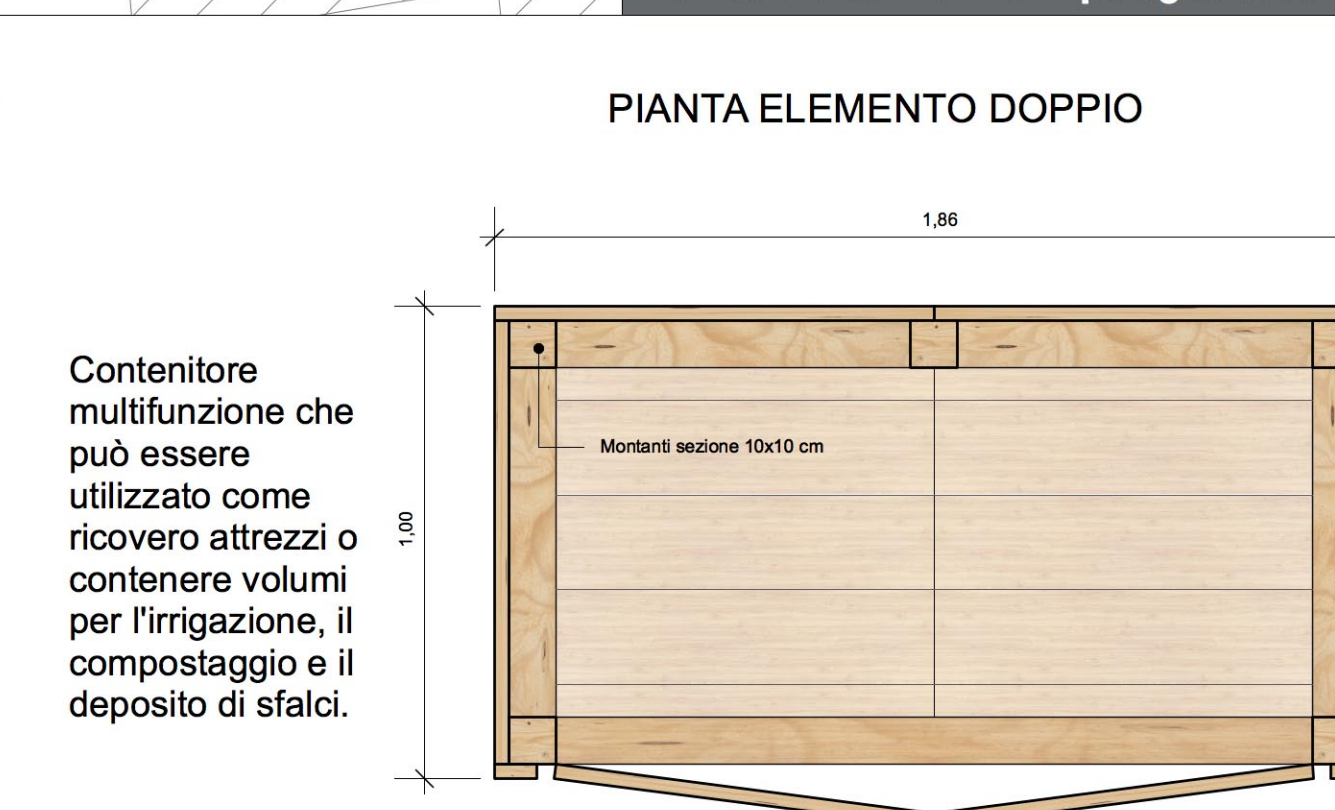
Particolare costruttivo - Contenitore multifunzione in legno
