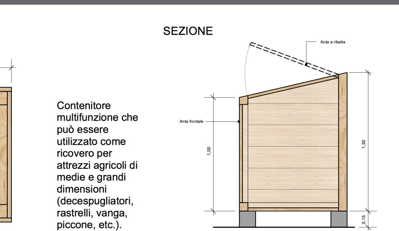
Particolare costruttivo - Contenitore multifunzione in legno
