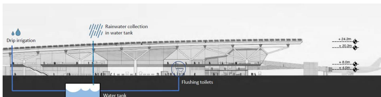
Figura 49 - Schema di recupero e riutilizzo acque meteoriche
