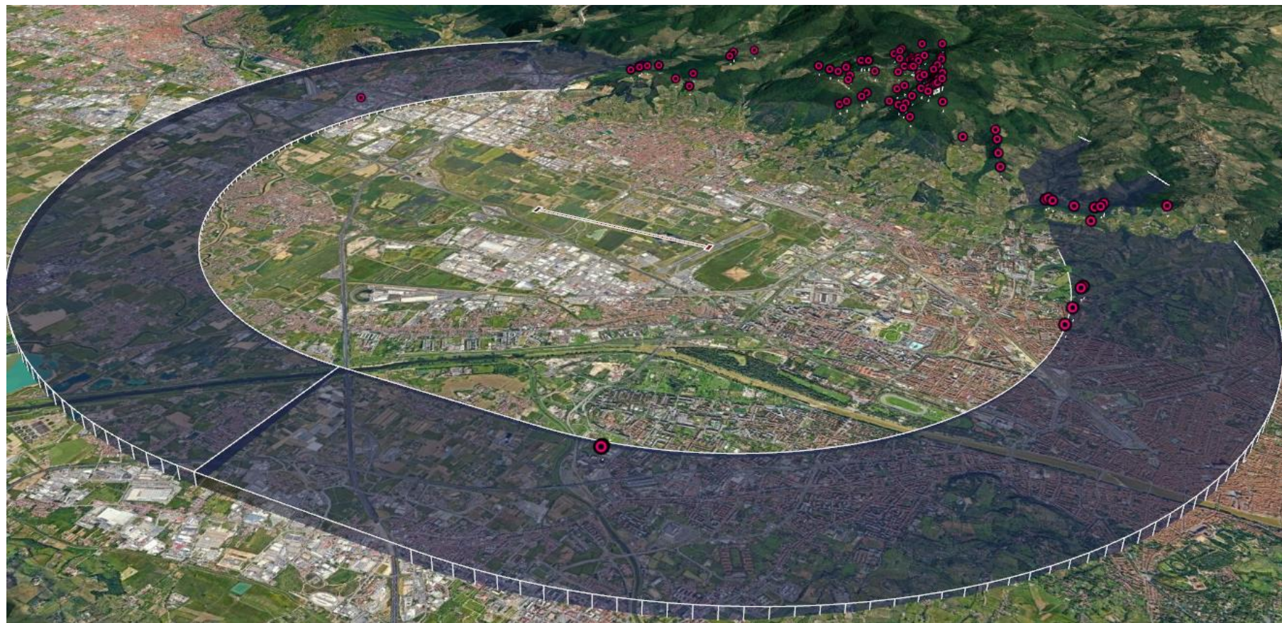
Figura 33 – Ostacoli che forano la superficie conica della pista 11/29
