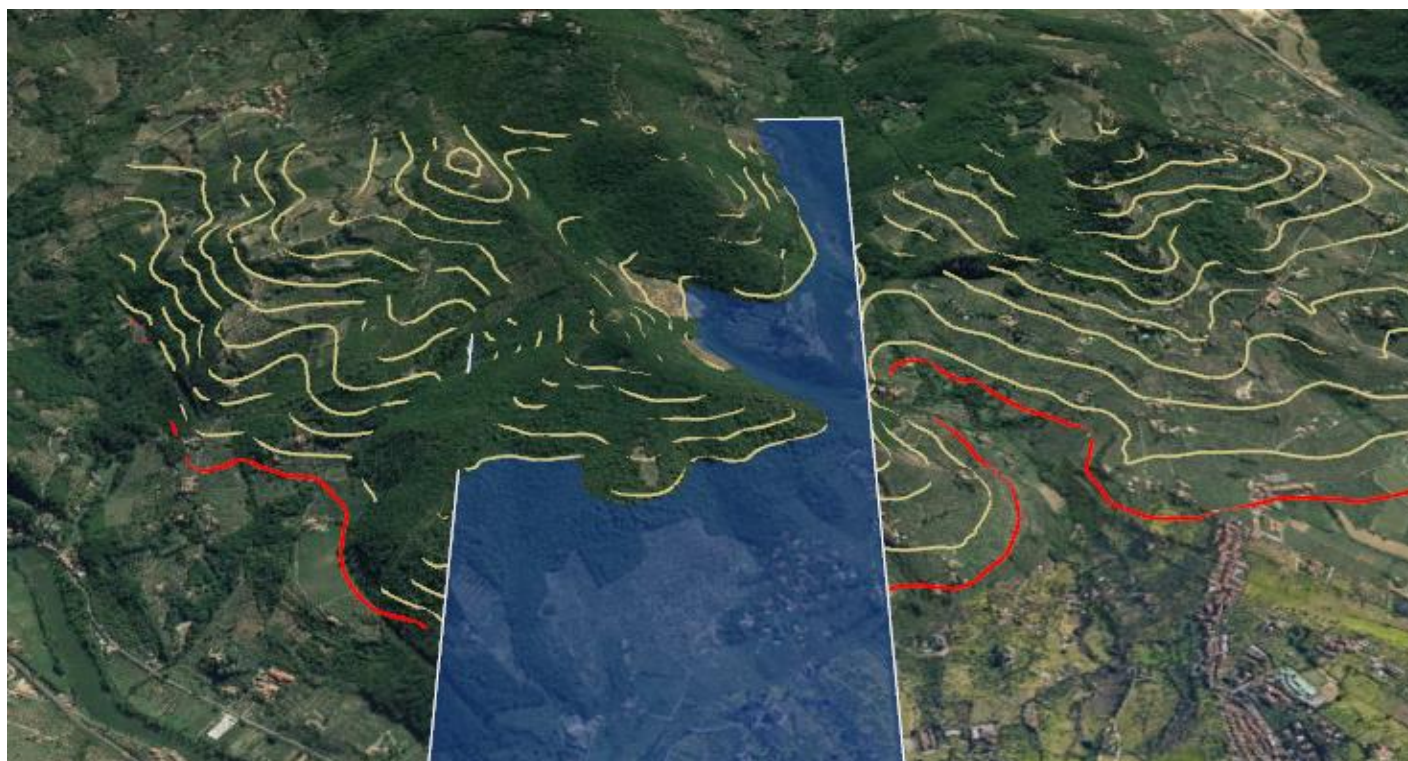
Figura 36 – Terreno che fora la superficie di decollo della pista 29
