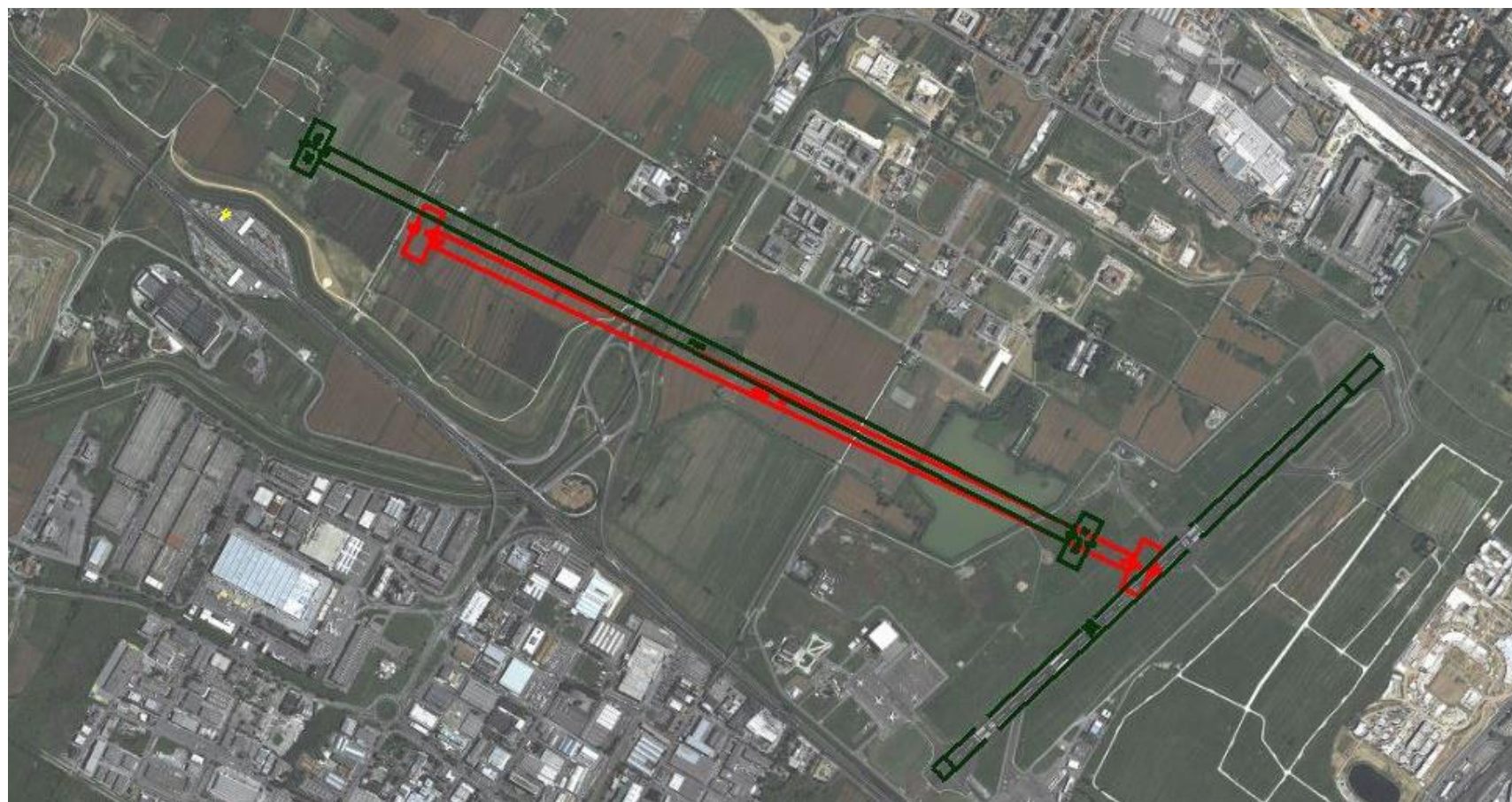
Figura 3 – pista 05/23, precedente progetto 12/30 e nuova pista RWY 11/29 - Aeroporto di Firenze
