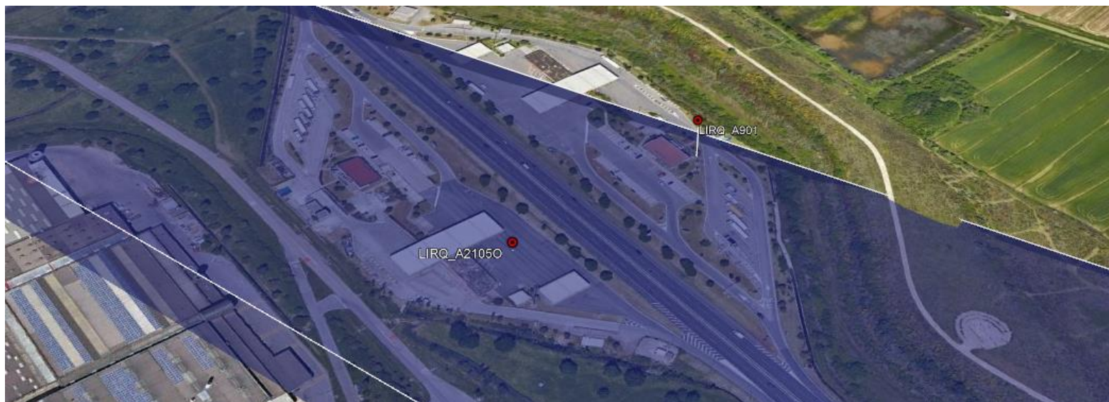
Figura 28 – Torri faro area di servizio che forano la superficie di transizione della pista 11/29
