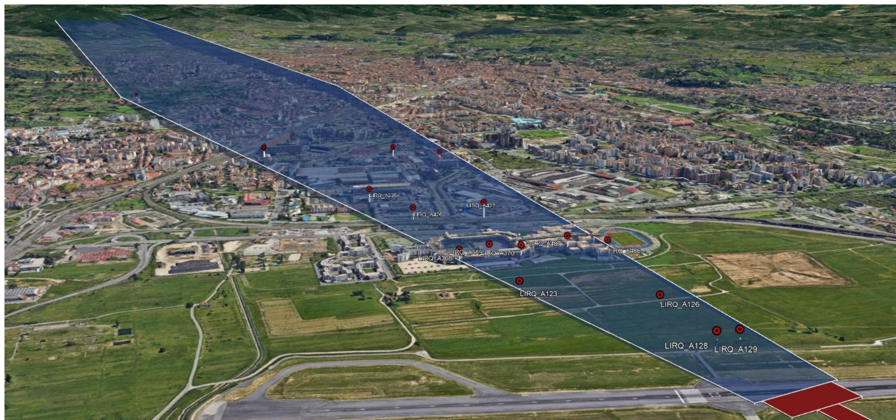
Figura 35 – Ostacoli che forano la superficie di decollo della pista 29
