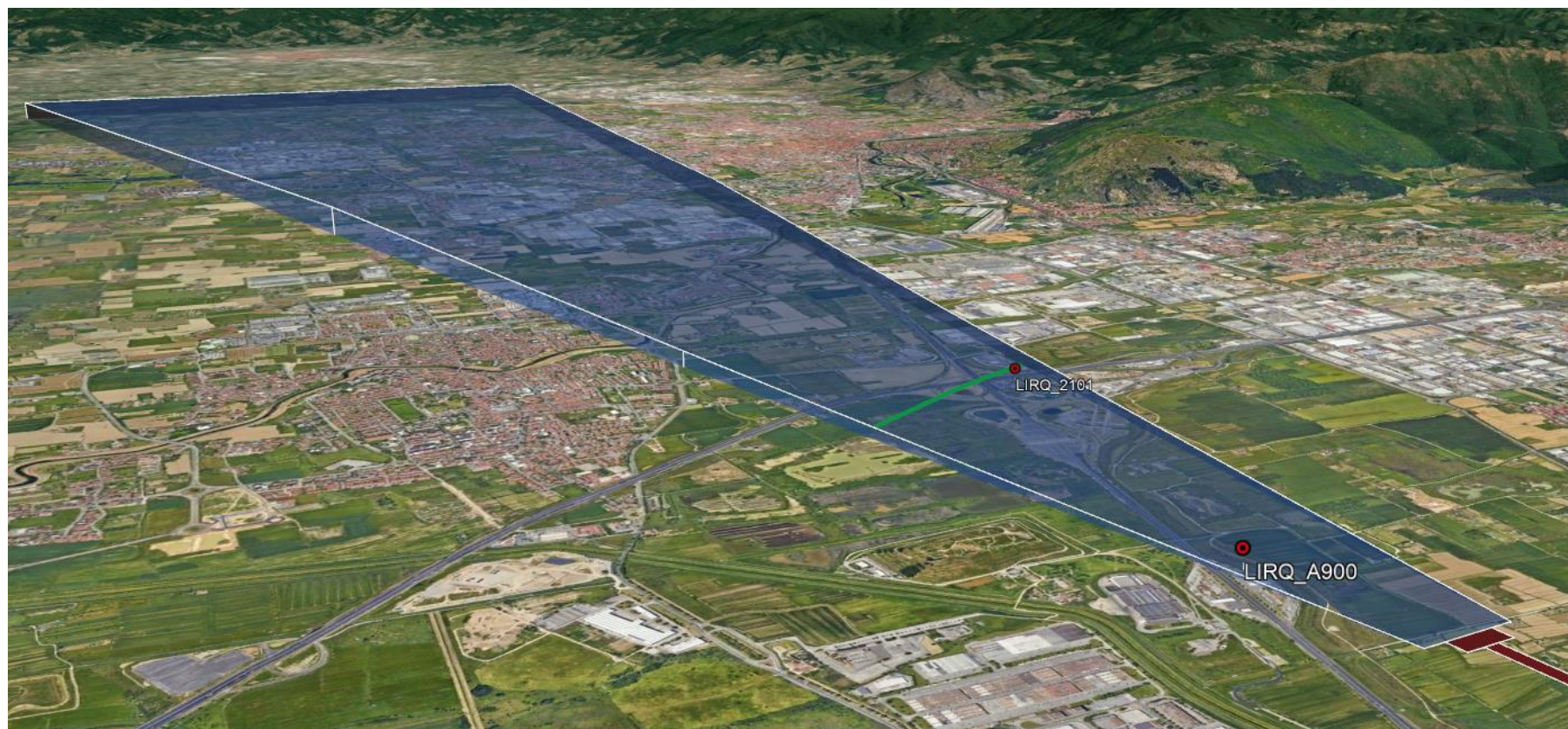
Figura 23 – Approach Surface RWY 11 (in verde la linea elettrica A.T. che non fora)
