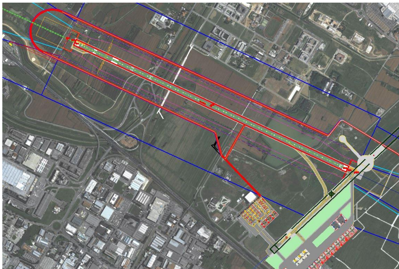
Figura 4 –nuova pista e nuovo layout RWY 11/29 - Aeroporto di Firenze
