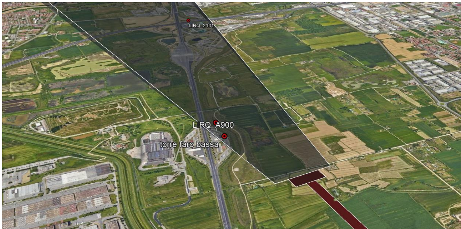
Figura 22 – Ostacoli che forano la Approach Surface RWY 11
