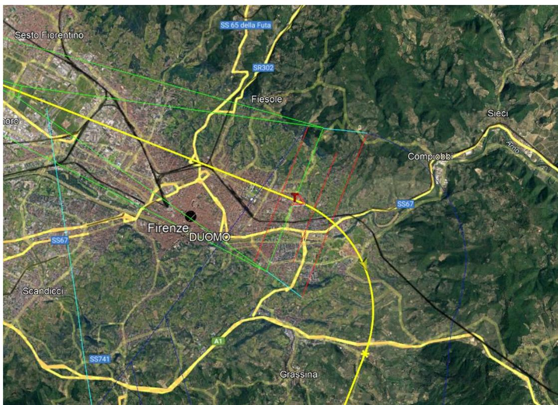
Figura 5 – Mancato Avvicinamento RWY11 virata on fix 5.8 NM FPT DME (gradiente di salita 2.5%) in Google earth
