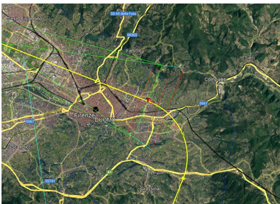
**Figura 7 – Mancato Avvicinamento RWY12 virata on fix 5.8 NM FPT DME (gradiente di salita 3.0%) in Google earth**
