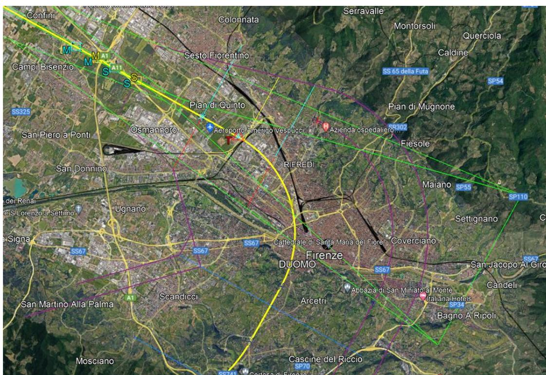
**Figura 12 – Mancato avvicinamento RWY12 virata on WPT (gradiente di salita 2.5%)
