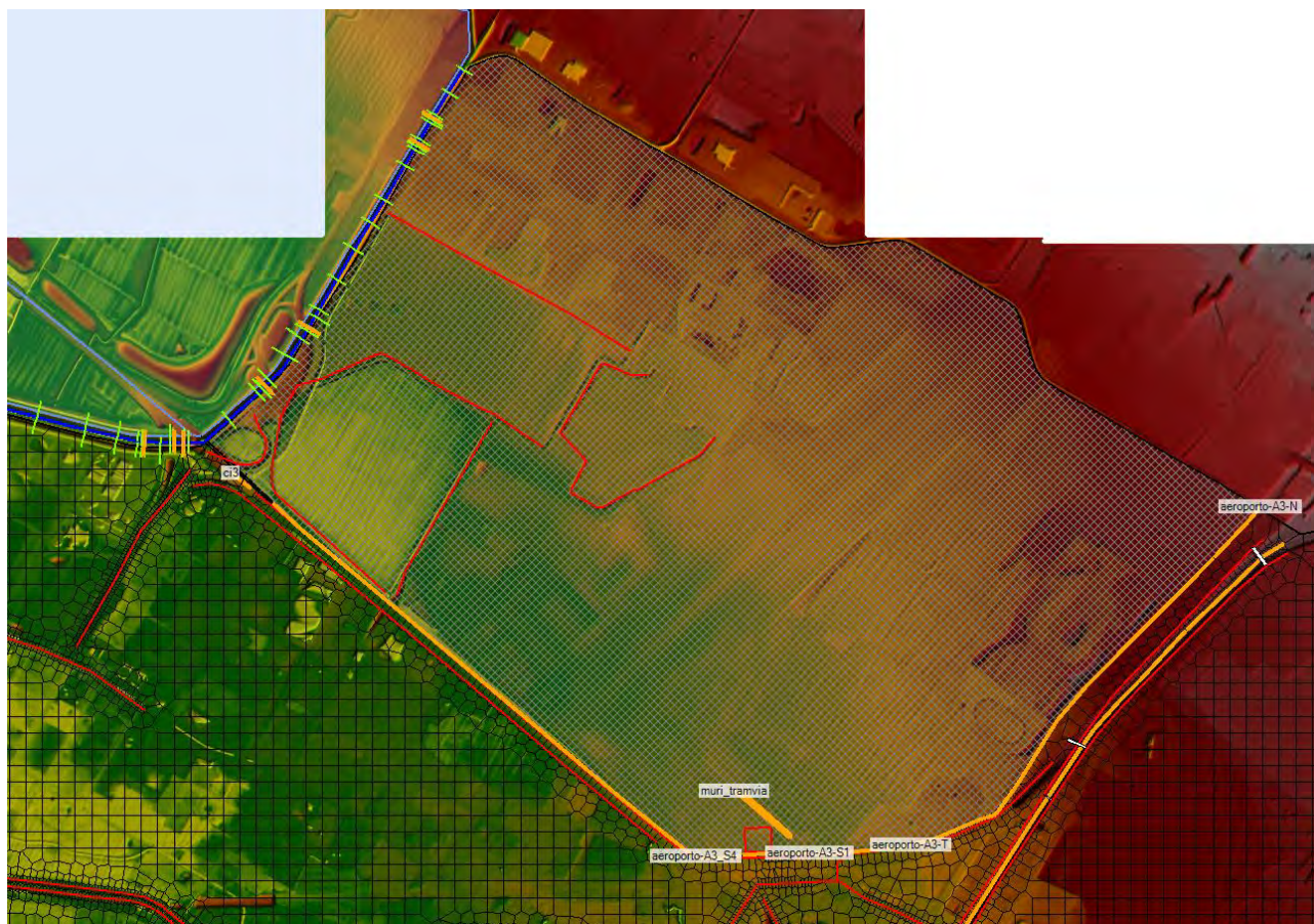
Figura 3-2 – F. Arno – Dettaglio del modello bidimensionale
