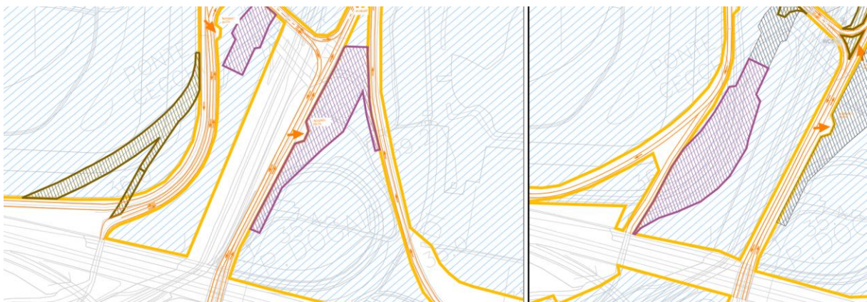
Figura 28 – Rampe di accesso provvisorie all'autostrada A11 e a Case Passerini
