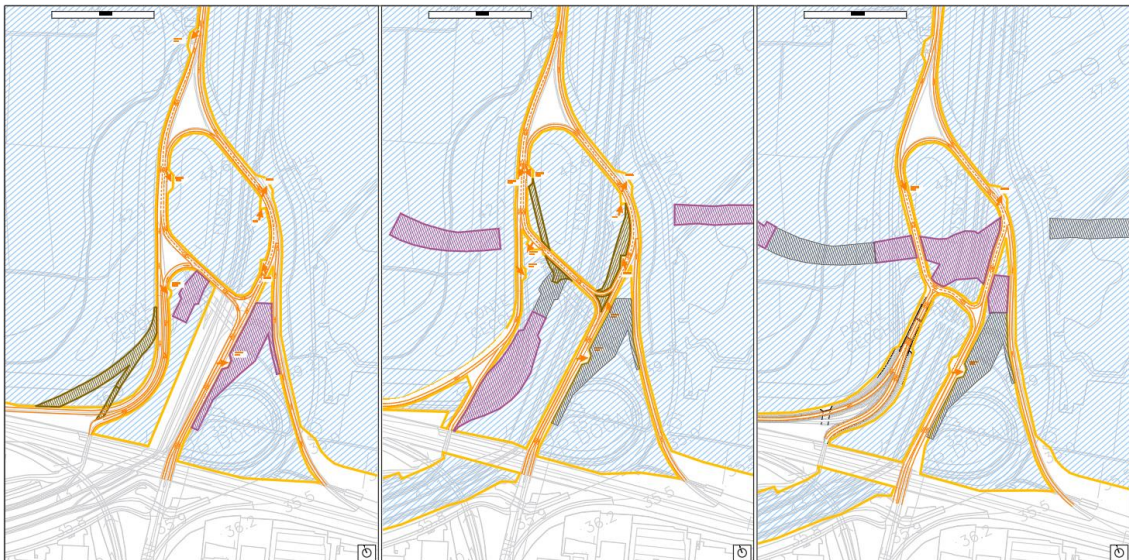
Figura 27 – Fasi di cantierizzazione nodo viario B
