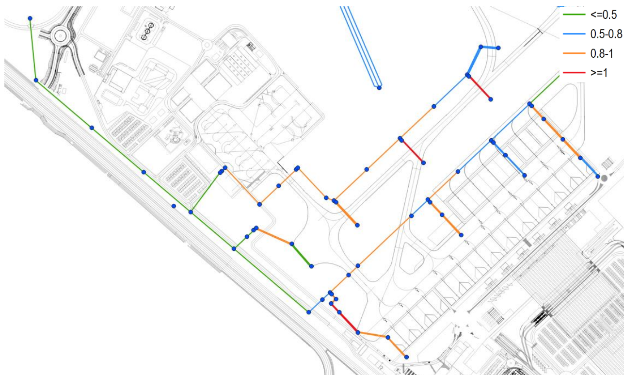
Figura 12: Grado di riempimento massimo per le tubazioni della rete Taxiway e Apron100 e completamento dell'APRON100. Involuppo TR 30 anni
