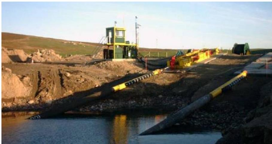
**Figura 24: Foto di un esempio di collegamento all'argano su rampa inclinata.**
