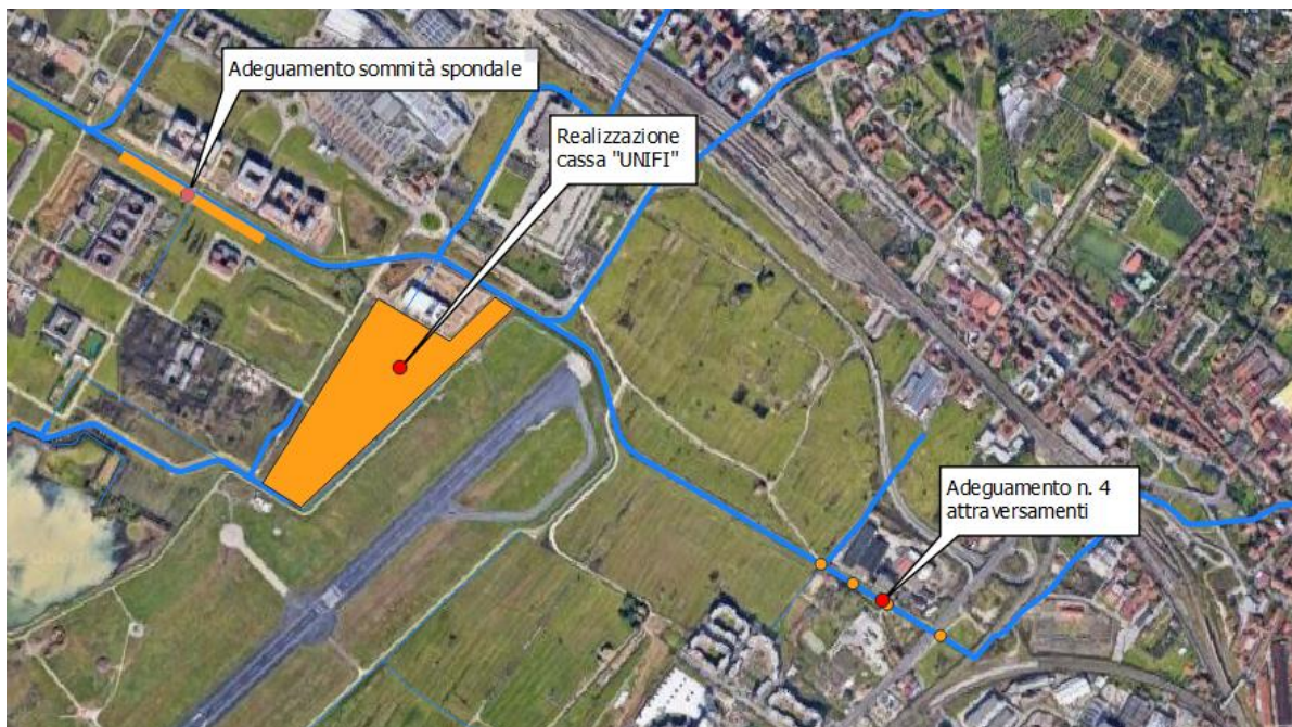
Figura 5-2 – Canale di Cinta Orientale – Interventi di progetto previsti nel Masterplan Aeroportuale e nel PUE di Castello
