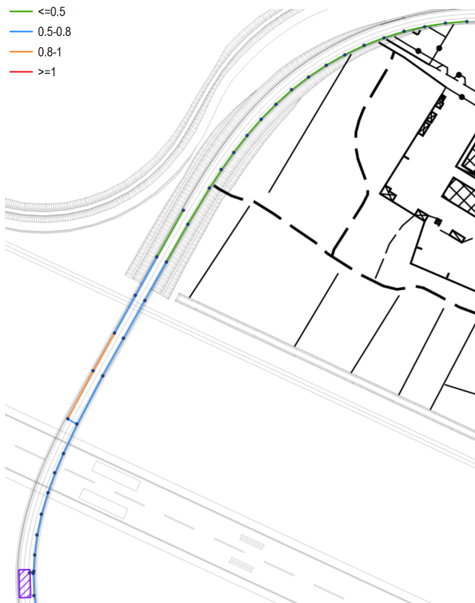
Figura 4: Grado di riempimento massimo per le tubazioni del sottopasso NORD. Inviluppo TR 30 anni
