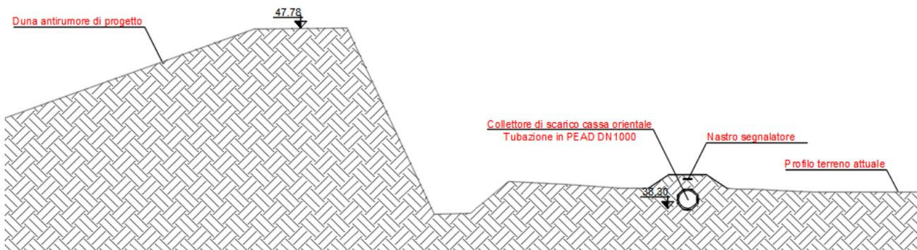
**Figura 2. Sezione tipologica del rilevato dunale lato Polo Universitario e del collettore cassa orientale**
