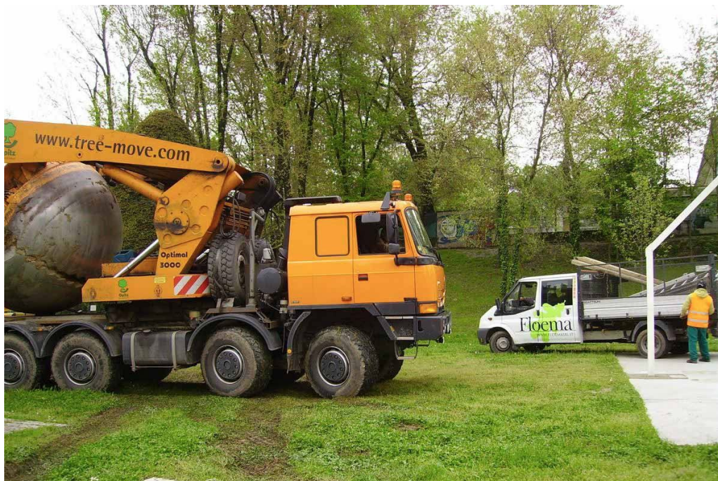
Figura 11. Sollevamento idraulico del sistema albero (parte epigea + zolla) sul pianale e avvio delle operazioni di successivo trasporto al sito di destino
