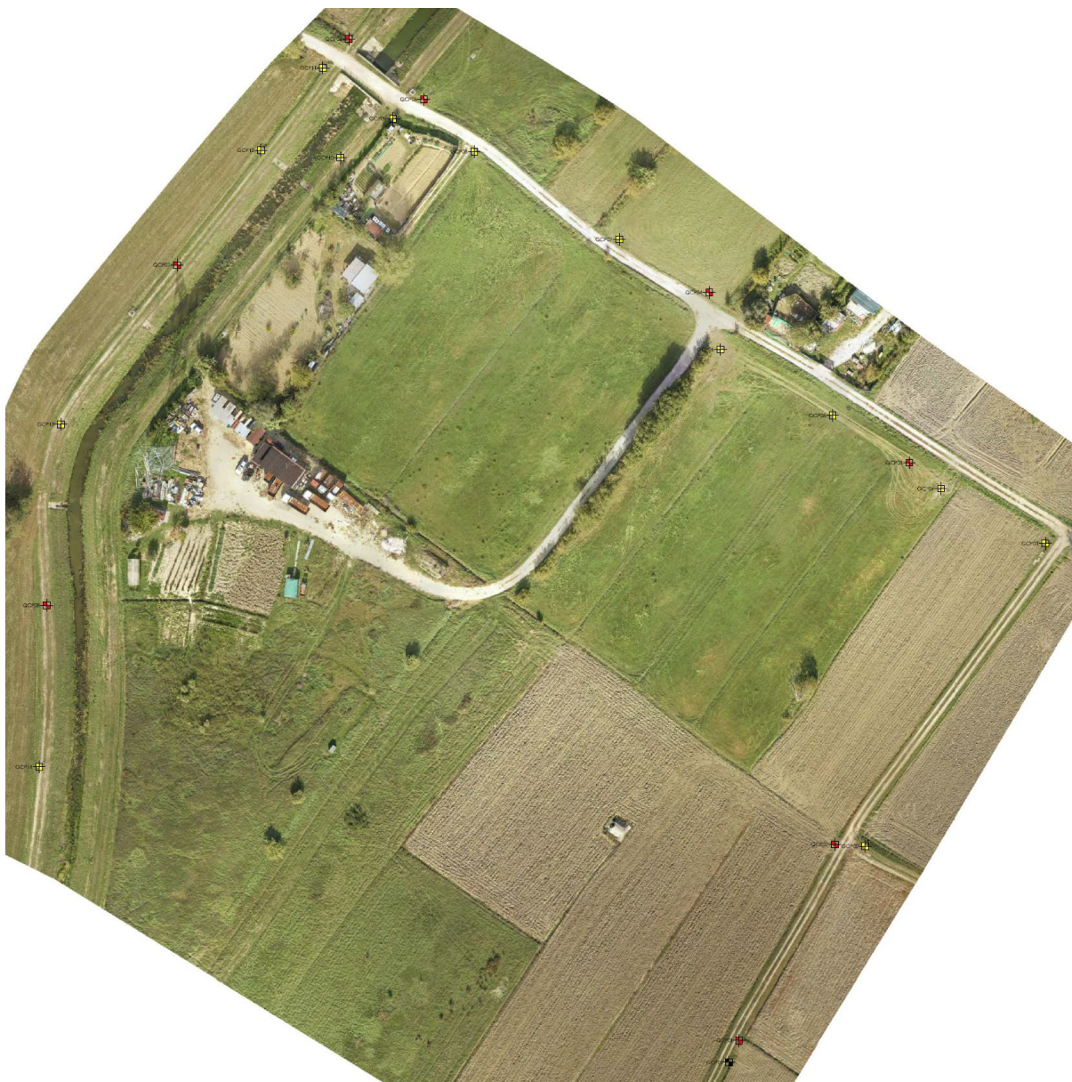
Figura 9: Posizionamento dei G.C.P. e Q.C.P. su ortofoto risultante dall'elaborazione dei dati acquisiti.
