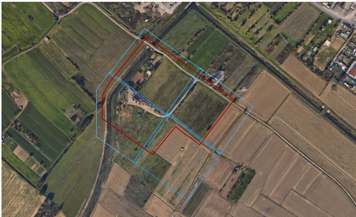
Figura 6: Suddivisione dell'area oggetto di rilievo in quattro sotto-aree omogenee. In colore rosso è riportata la porzione di territorio per la quale è stata richiesta l'integrazione topografica.
