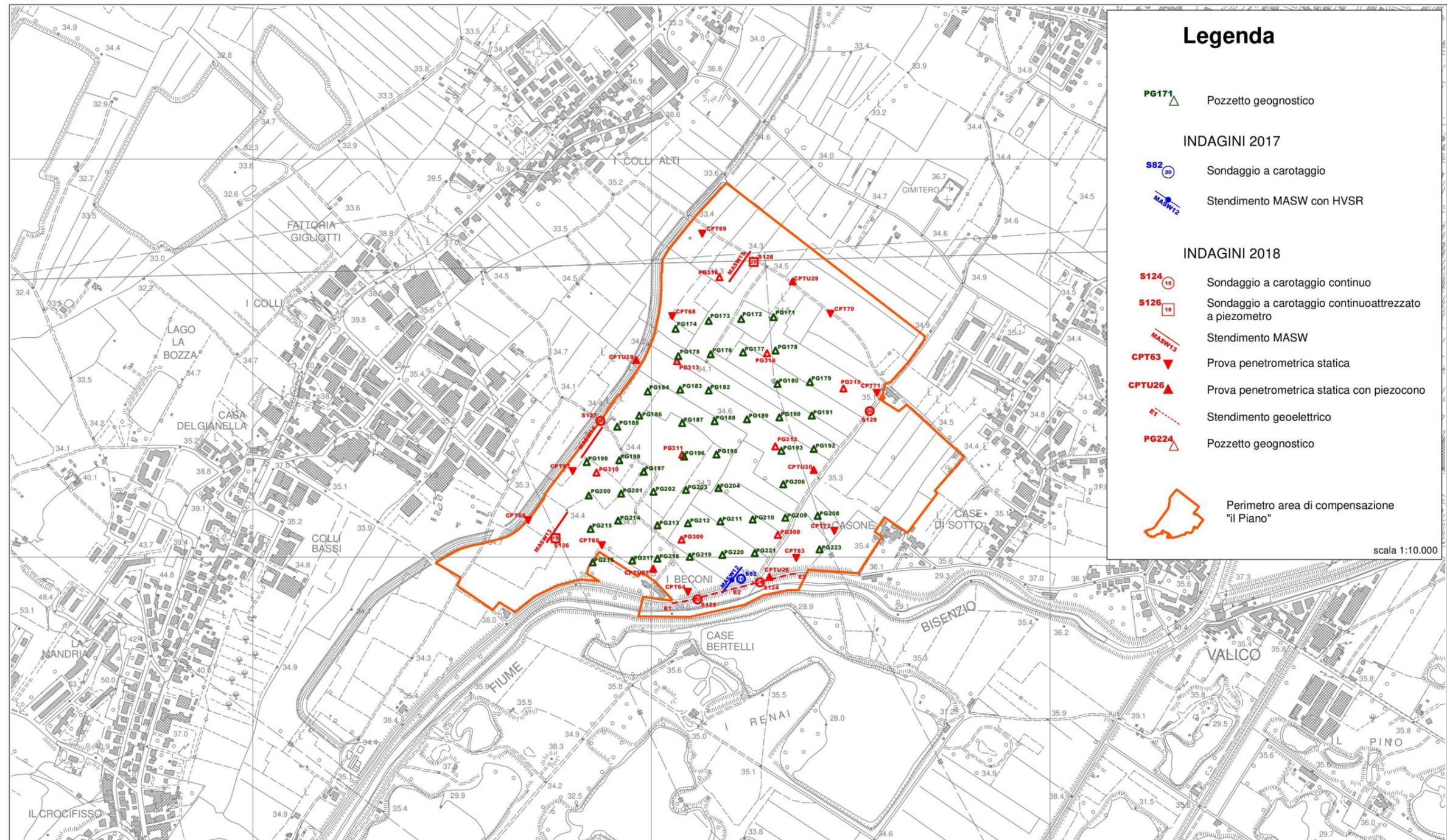
Figura 6 - Ubicazione delle indagini geognostiche realizzate in scala 1:10.000.
