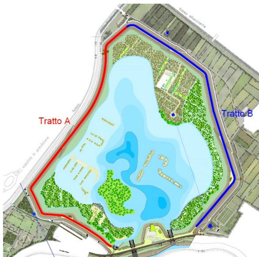
Figura 3-1: Estratto della planimetria di progetto con indicati i tratti arginali con paramenti a diversa pendenza (1:2 interna, 1:2 esterna per Tratto A; 1:2 interna, 1:3 esterna per Tratto B)
