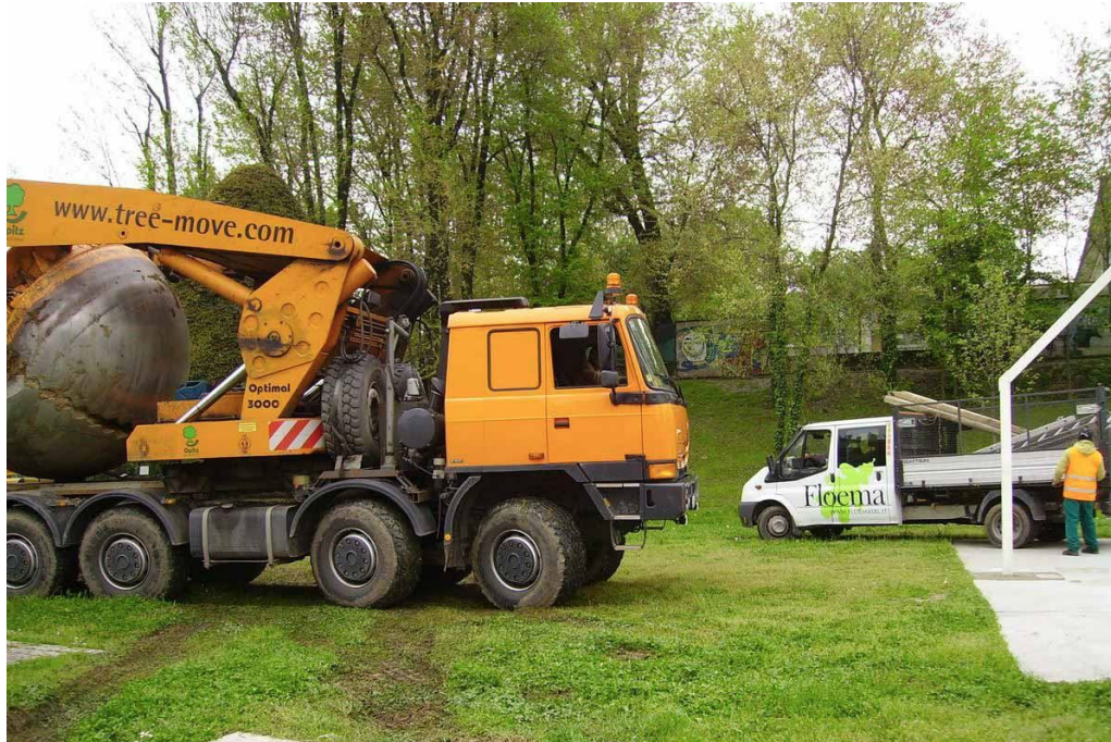
Figura 26. Sollevamento idraulico del sistema albero (parte epigea + zolla) sul pianale e avvio delle operazioni di successivo trasporto al sito di destino
