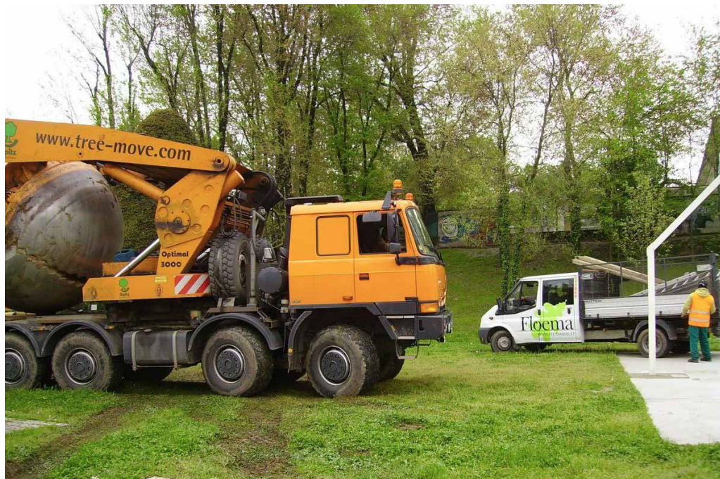
Figura 27. Sollevamento idraulico del sistema albero (parte epigea + zolla) sul pianale e avvio delle operazioni di successivo trasporto al sito di destino
