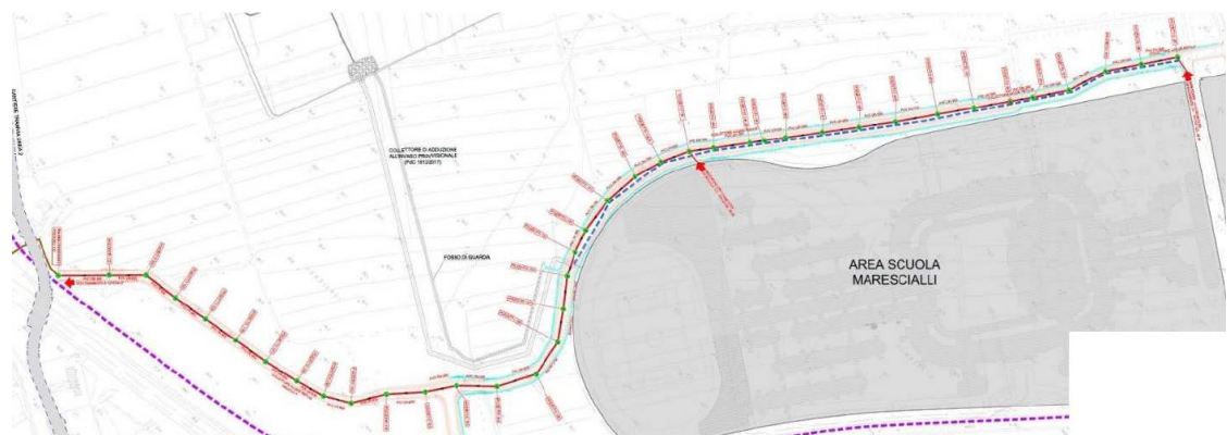
Figura 39: Collettore principale acque reflue
