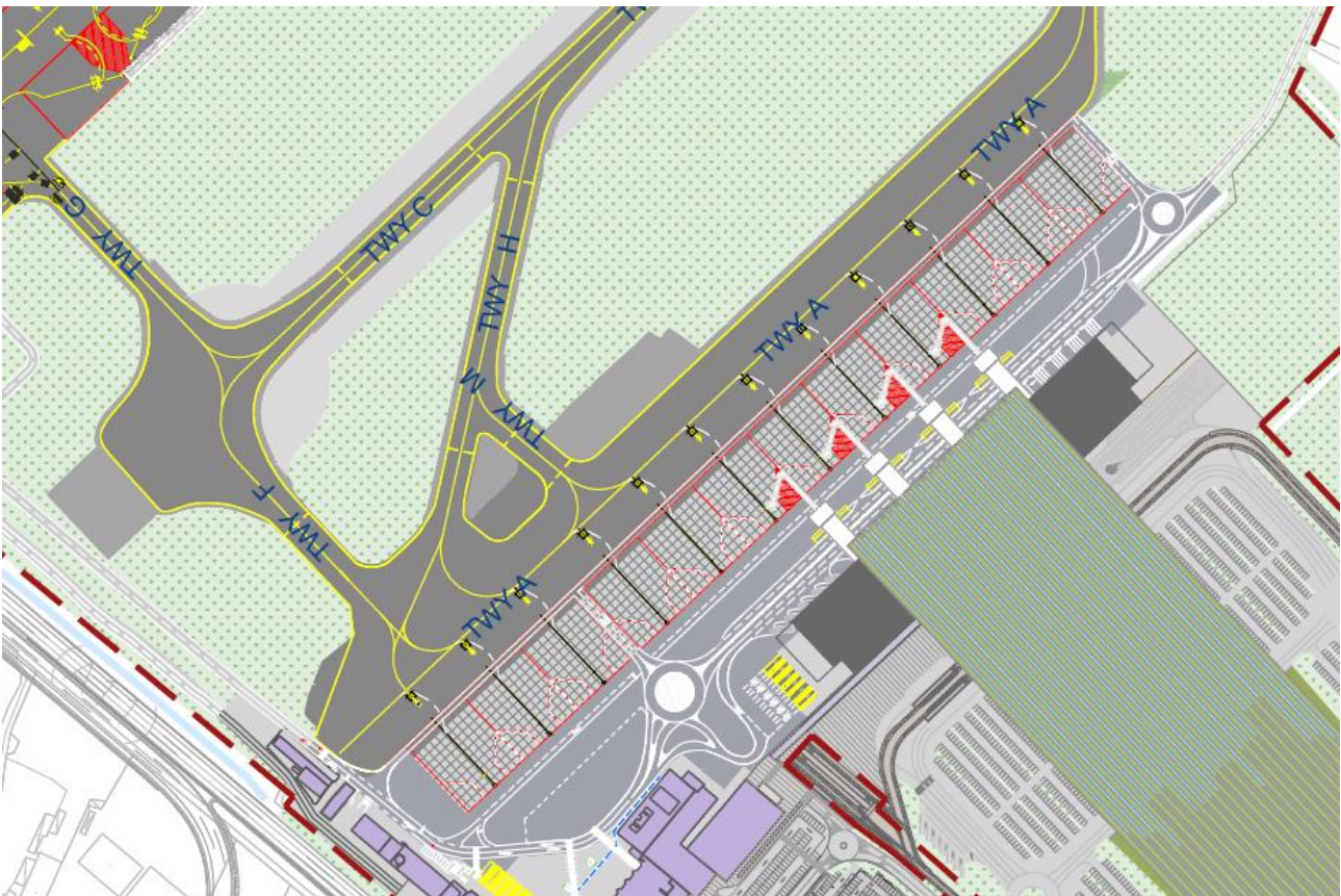
Figura 40 | Schema funzionale e senso di circolazione del nuovo Apron.
