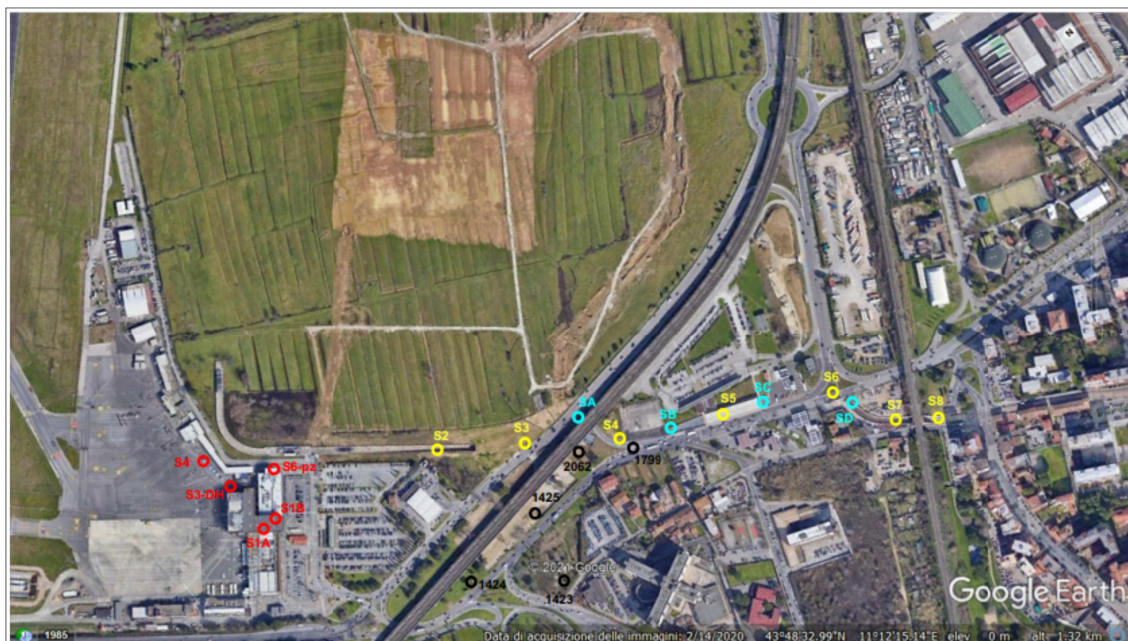
Figura 9 - Sondaggi in area terminal e trincea Guidoni tramvia linea 2.
