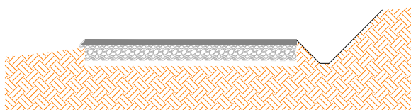
Fig. 10 - Sezione tipo tratto a mezza costa
