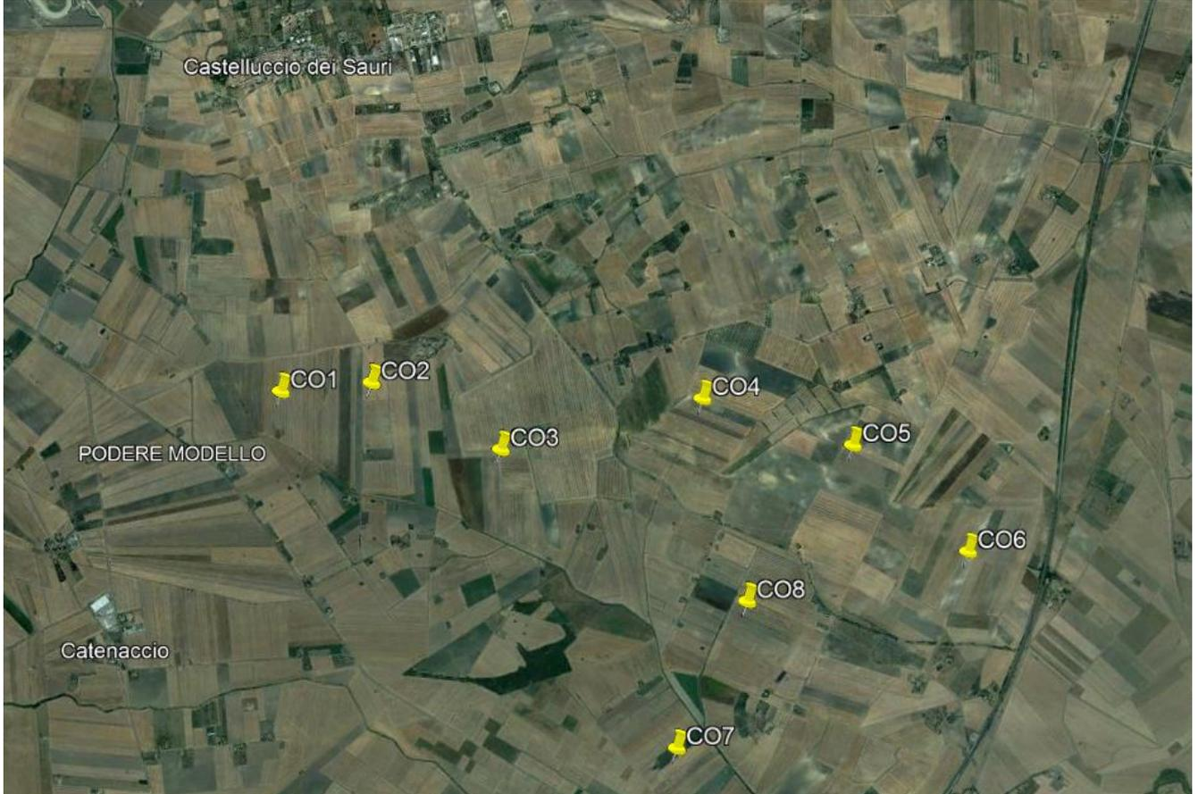
La società sta sviluppando un progetto che prevede la realizzazione di un impianto eolico costituito da 8 aerogeneratori della Vestas, modello V150, ciascuno della potenza di 6MW per una potenza nominale di complessiva dell'impianto eolico pari a 48 MW. Gli aerogeneratori sono indicati col suffisso CO.
