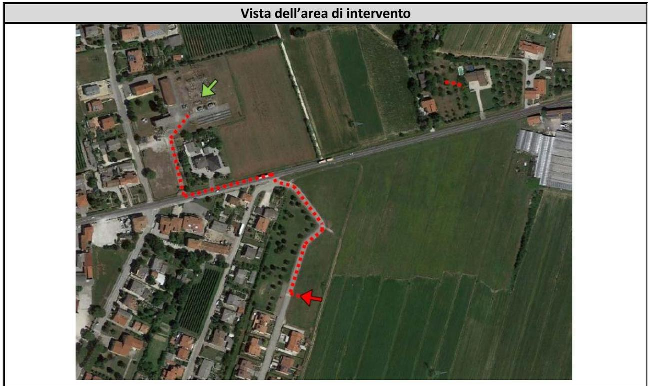
L'allacciamento del parco fotovoltaico in progetto prevede la necessità di realizzare un elettrodotto di rete, con collegamento in antenna presso la Cabina Primaria AT/MT “Levada” Il tracciato è rappresentato quindi dal collegamento, dello sviluppo di circa 450 m, tra la nuova cabina MT/BT “FIN.CI.” e la cabina AT/MT esistente “LEVADA”.
