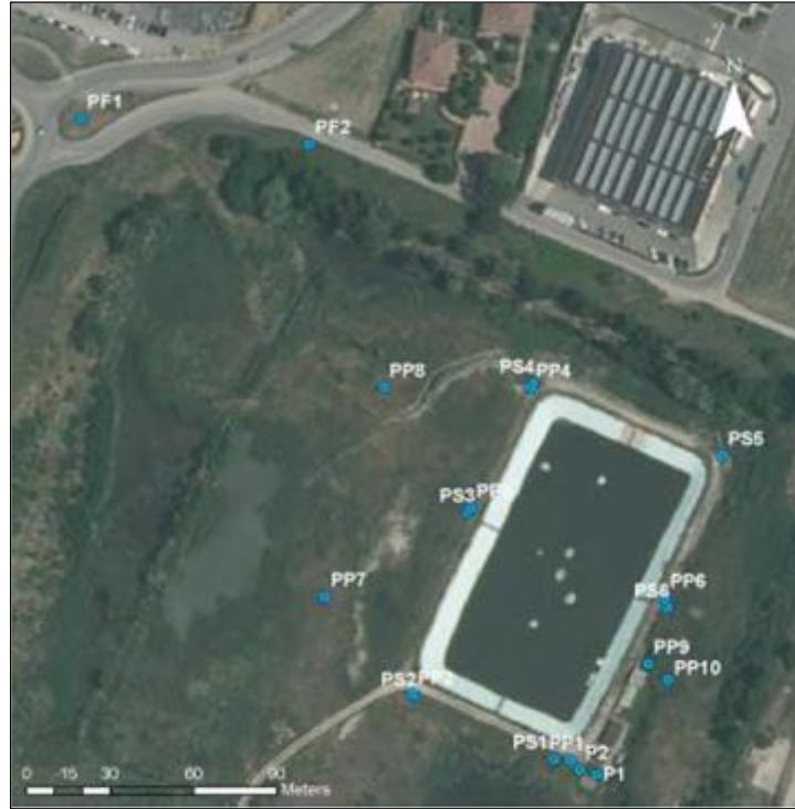
Figura 9 – Ubicazione dei piezometri di monitoraggio (2013 e 2015) per lo Studio Idrogeologico dell'area di Cava Olmi – Dipartimento di Scienze Chimiche e Geologiche UNIMORE)
