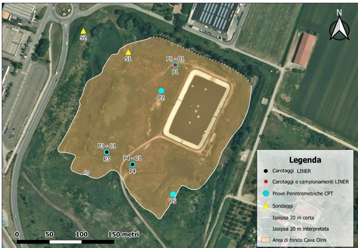
Figura 25 - Ubicazione indagini geognostiche delle campagne di dicembre 2019 e gennaio 2020 eseguite nell'area di impronta dell'abbancamento di progetto
