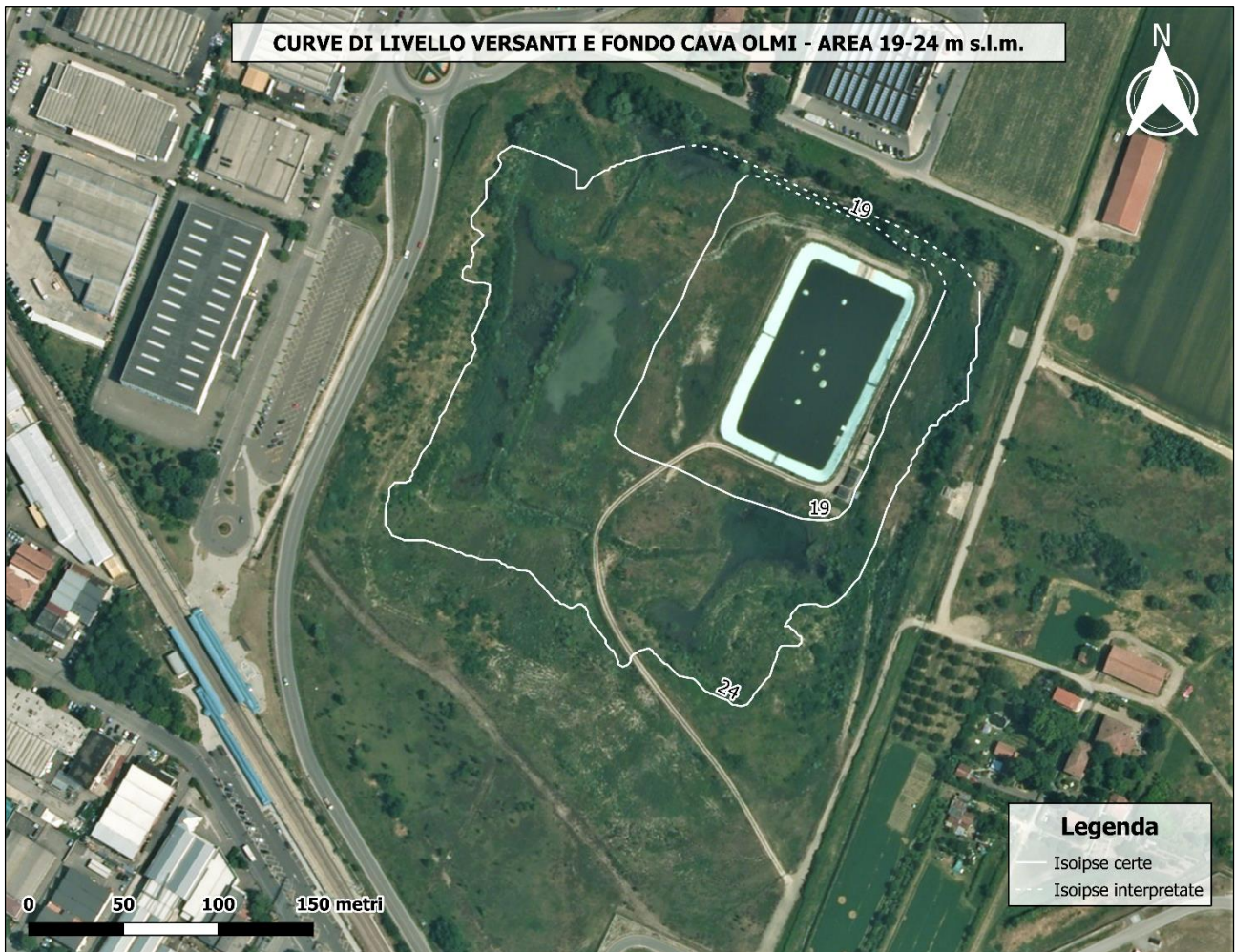
Figura 42 – Area compresa tra le quote 19 e 24 m s.l.m., all'interno della quale è stata individuata la zona di abbancamento sul fondo della cava
