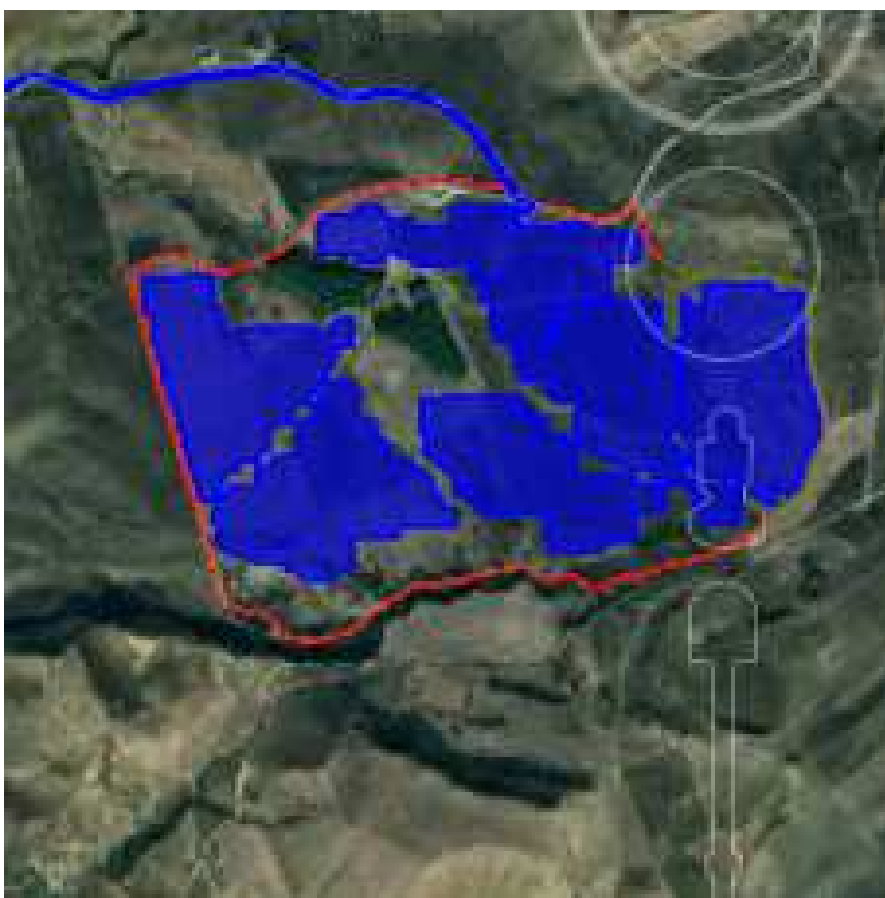
Figura 5: Ortofoto con individuazione del confine di proprietà ed ubicazione dei moduli fotovoltaici (in blu)
