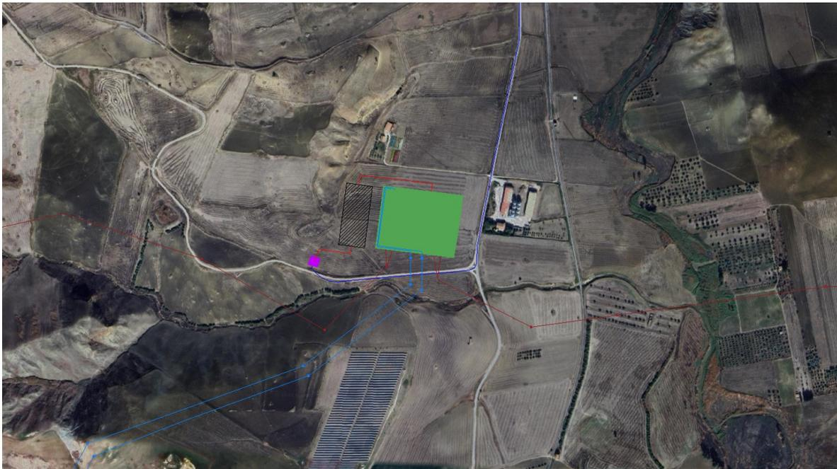
Figura 5: Ortofoto con individuazione della Cabina di Sezionamento (in magenta) dell'Ampliamento a 36kV (in nero) e della SE (in verde)
