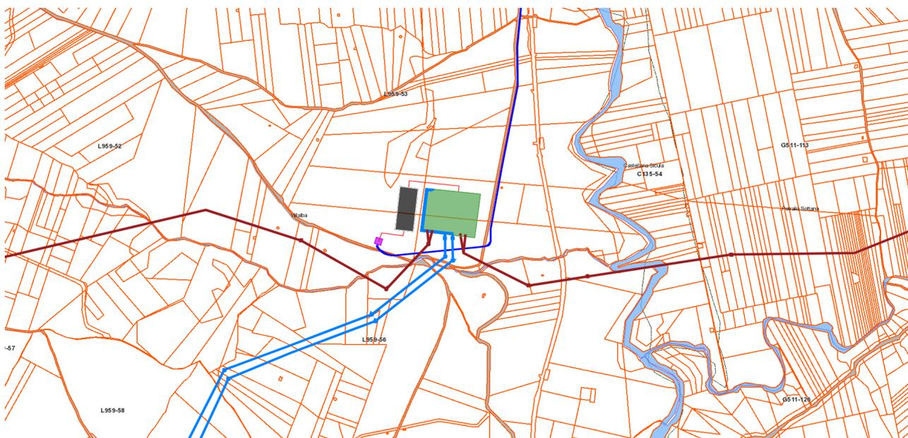
Figura 9: Stralcio del foglio di mappa n.53 – Comune di Villalba - con individuazione della Cabina di Sezionamento (in magenta) dell'Ampliamento a 36kV (in bianco) e della SE (in verde)
