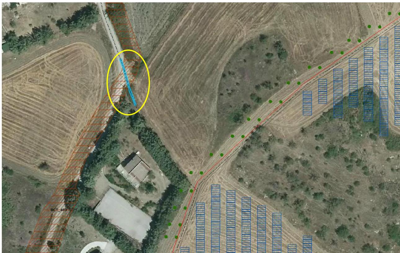
Figura 3.5. – Dettaglio dell’Interferenza (in giallo) del Cavidotto (in rosso) con il bene tutelato “Tratturo Cancellara – Stazione di Vaglio”.
