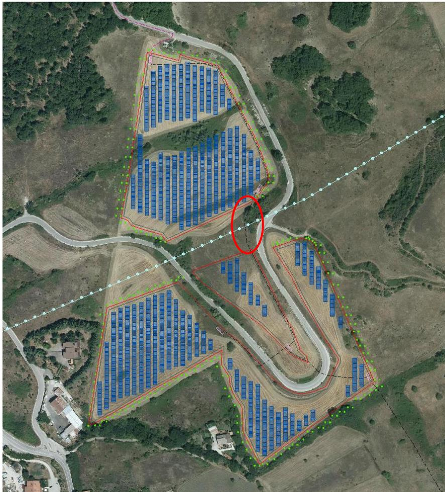
Figura 3.7. – Dettaglio (in rosso) dell'Interferenza del cavidotto interno con la rete di approvvigionamento idrico.
