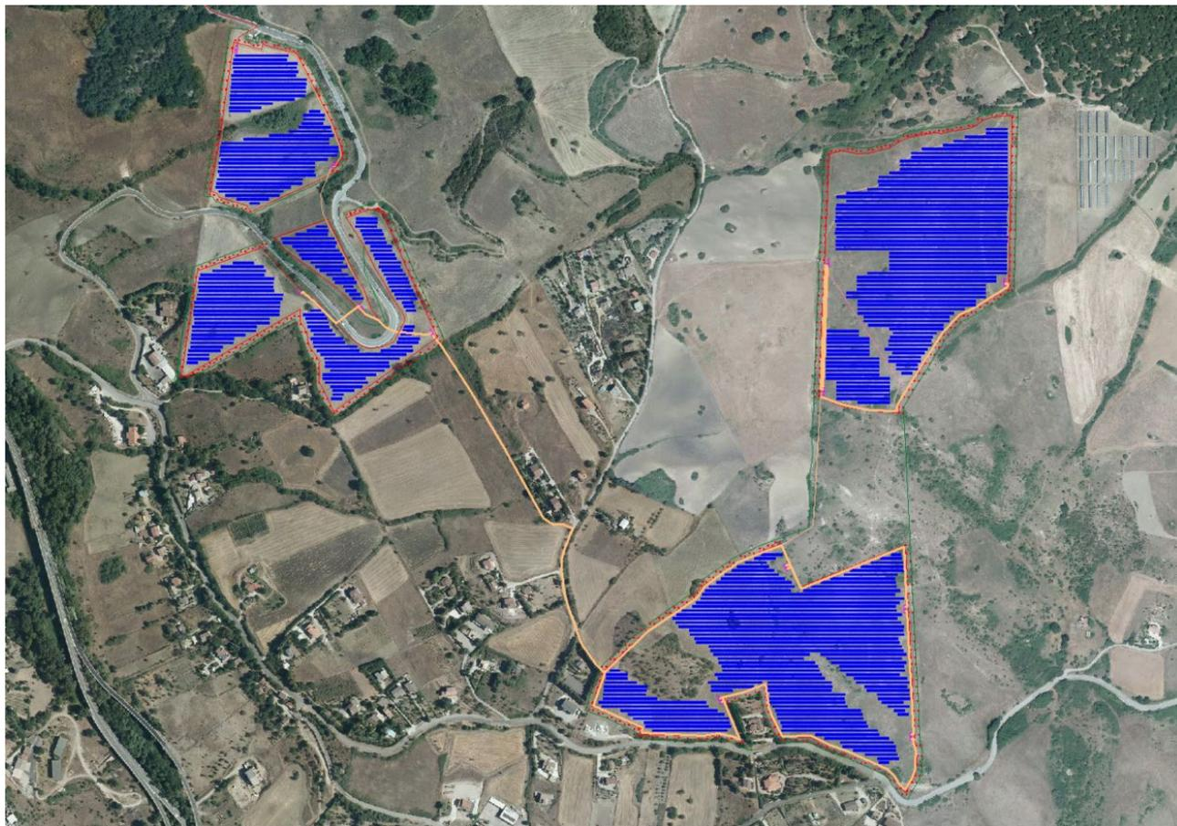
Figura 3.5. – Layout del sistema fotovoltaico con supporti fissi
