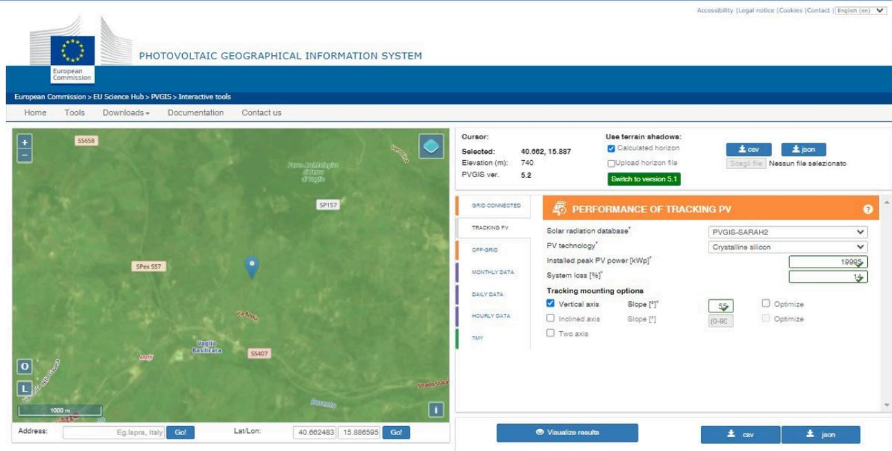
Figura 3.3. – Inserimento nell’applicativo della localizzazione dell’impianto e delle caratteristiche tecnico-produttive con tracker
