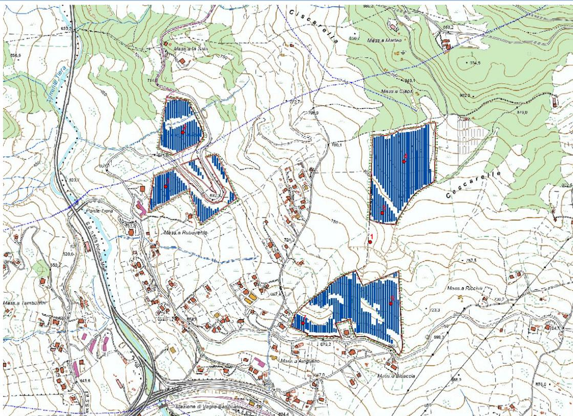
Figura 4.11. – Posizionamento delle stazioni meteorologiche su base CTR.
