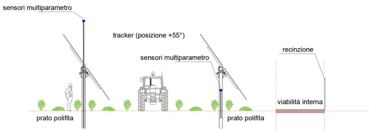
Figura 4.10. – Schema di posizionamento delle stazioni meteorologiche interne al campo agrivoltaico.
