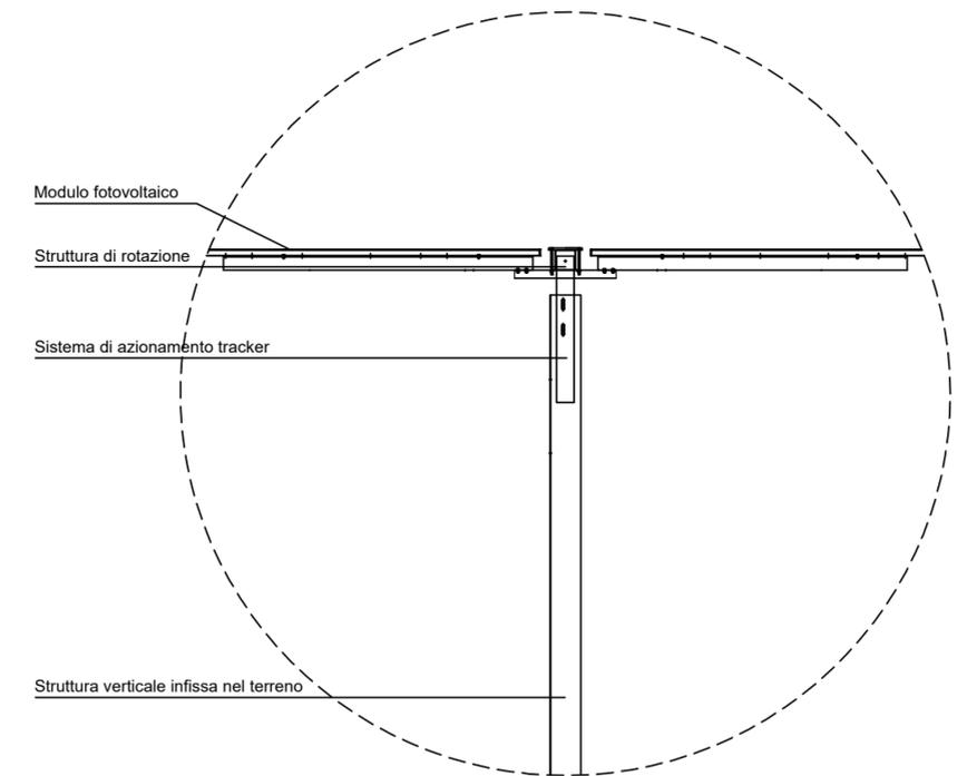
Tracker - Sezione di dettaglio
