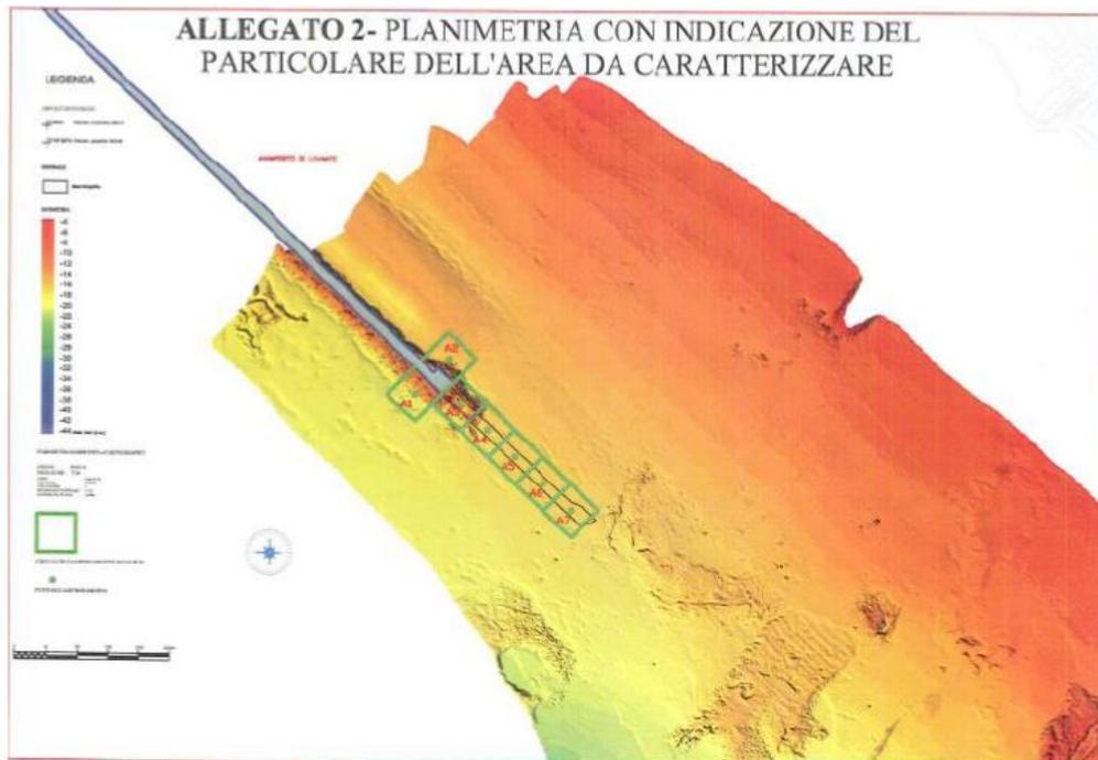
FIGURA 31 - PORTO DI NAPOLI - RILIEVO BATIMETRICO 2020 CON UBICAZIONE MAGLIE DI CARATTERIZZAZIONE PROLUNGAMENTO - DIGA..
