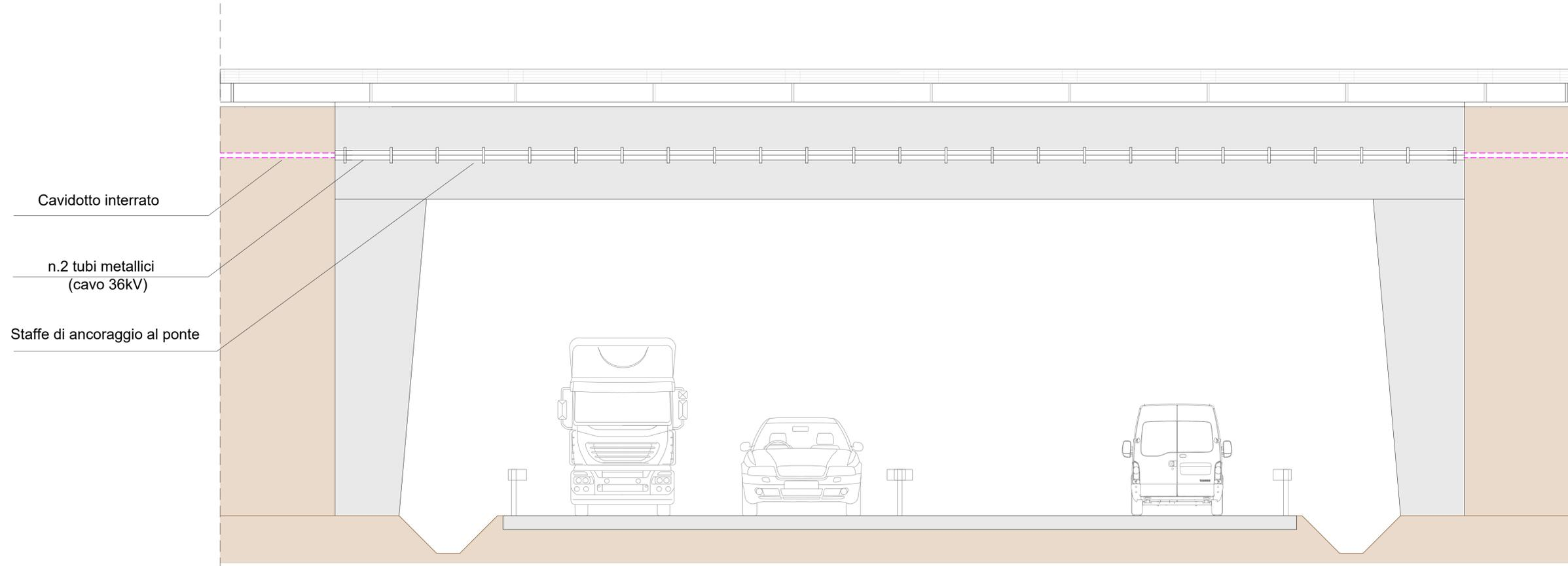
CAVIDOTTO 36kV - TIPOLOGICO ATTRAVERSAMENTO TRATTO FERROVIARIO CON ANCORAGGIO CAVI (INTERFERENZA I11) Scala 1:50
