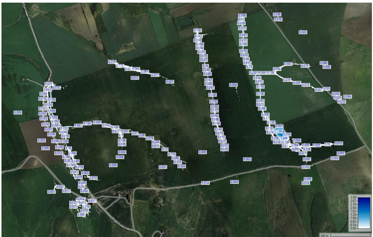
Figura 43 - Tiranti idrici massimi raggiunti per T=500 anni nell'area oggetto di intervento
