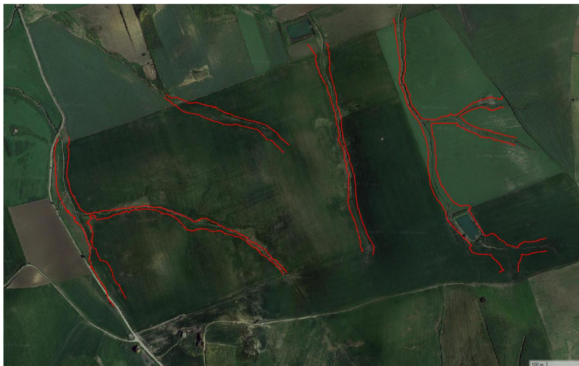
Figura 47 – Limite derivato dal franco idraulico di 1 m per la piena 500-ennale
