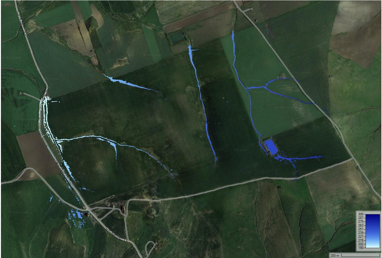
Figura 28 - Evoluzione della propagazione dell'acqua nell'area di intervento (T=50 anni)
