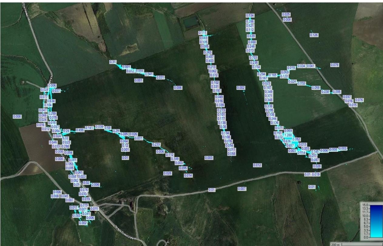
Figura 37 - Tiranti idrici massimi raggiunti per T=100 anni nell'area oggetto di intervento
