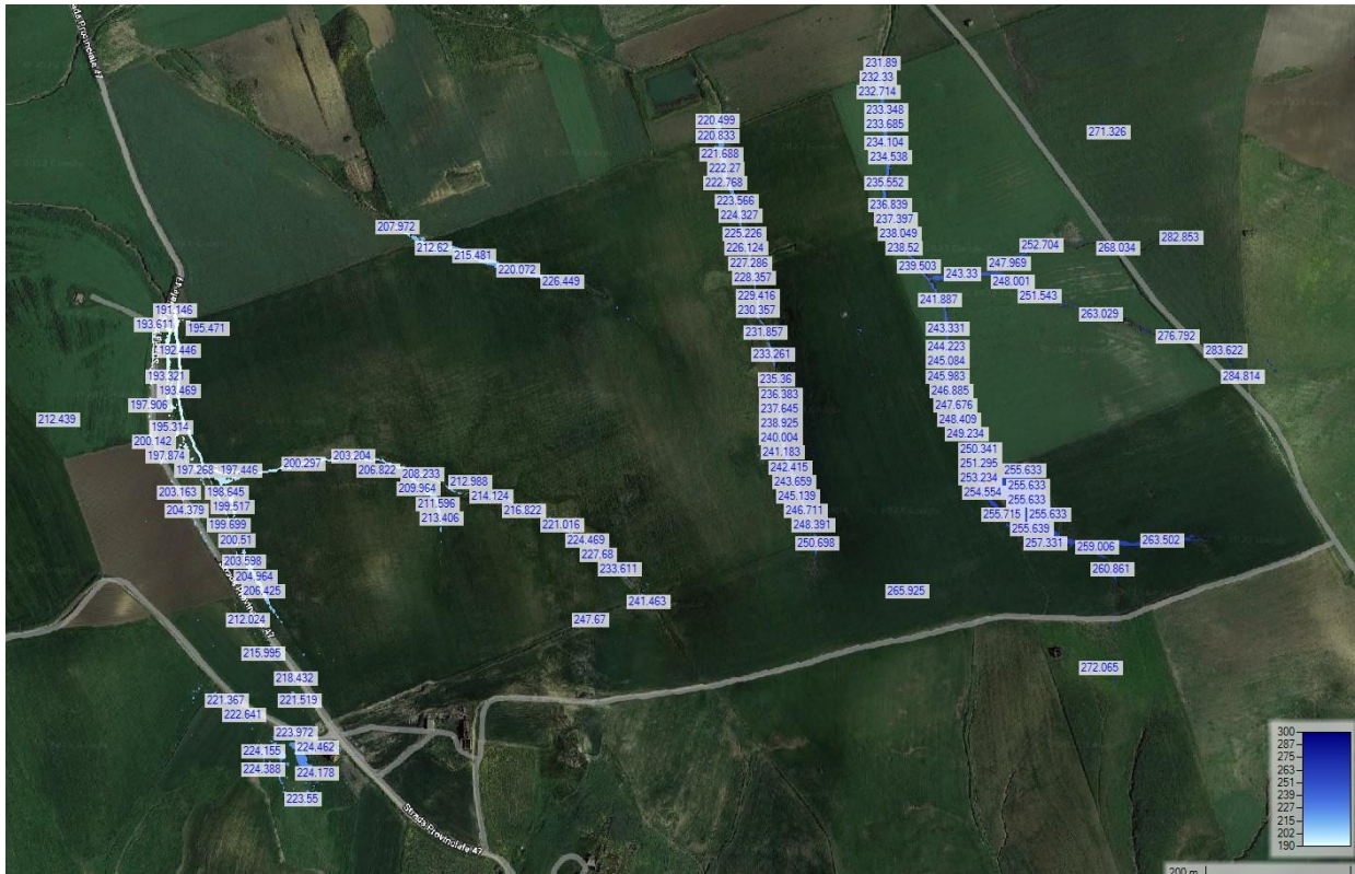
Figura 24 - Altezze idriche massime raggiunte per T=2 anni nell'area oggetto di intervento
