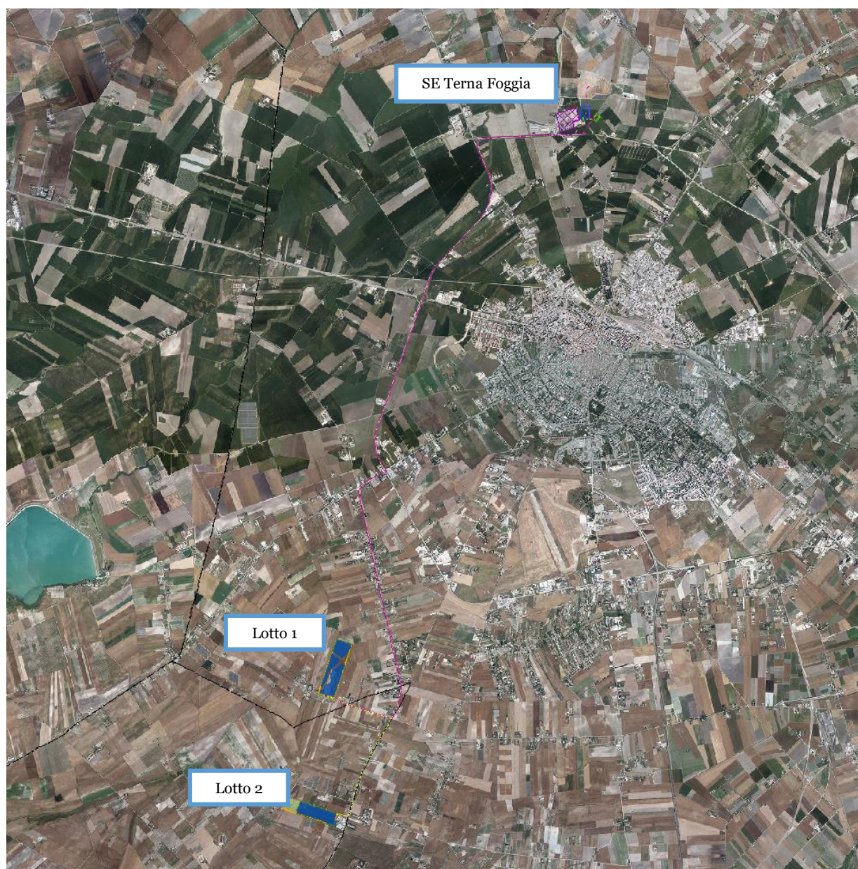
Figura 6.1. – Individuazione impianto in progetto, cavidotto esterno MT e futura stazione Terna S.p.A. su Ortofoto.
