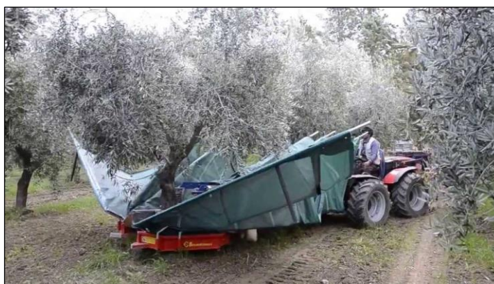
Fig. 13 - Raccolta meccanizzata con scuotitore meccanico e telo agevolatore per la raccolta
