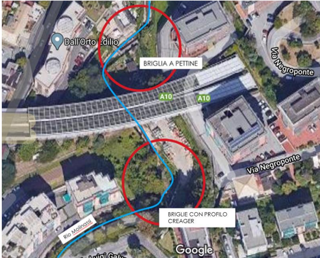
Figura 19 Ubicazione delle aree in cui è prevista la realizzazione tre delle briglie (una a funi e due a profilo Creager)
