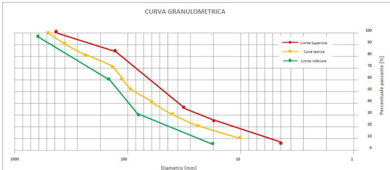
**Figura 1: Curva granulometrica Materiale Base A**
