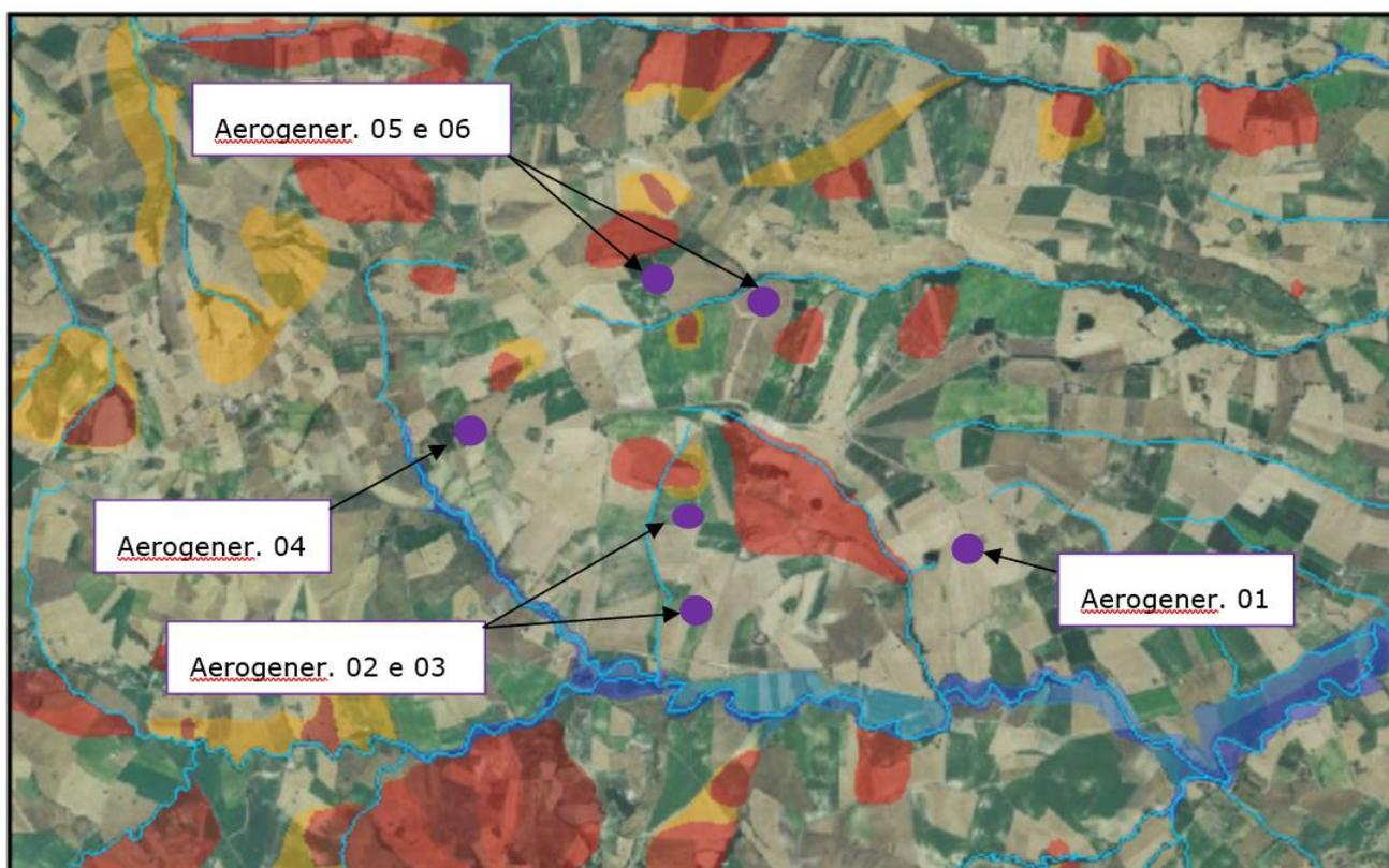
Fig. 6 - Perimetrazioni P.A.I. per Pericolosità da Frana (gradazioni di rosso) e Idraulica (grad. di blu)
