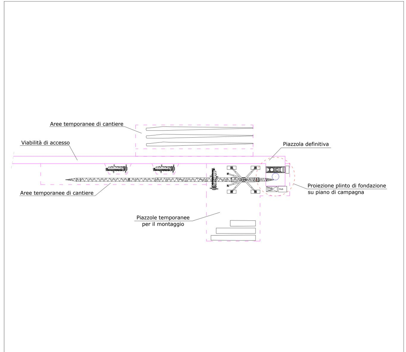
PLANIMETRIA DI DETTAGLIO VIABILITA' DI ACCESSO, AREE TEMPORANEE DI CANTIERE,
