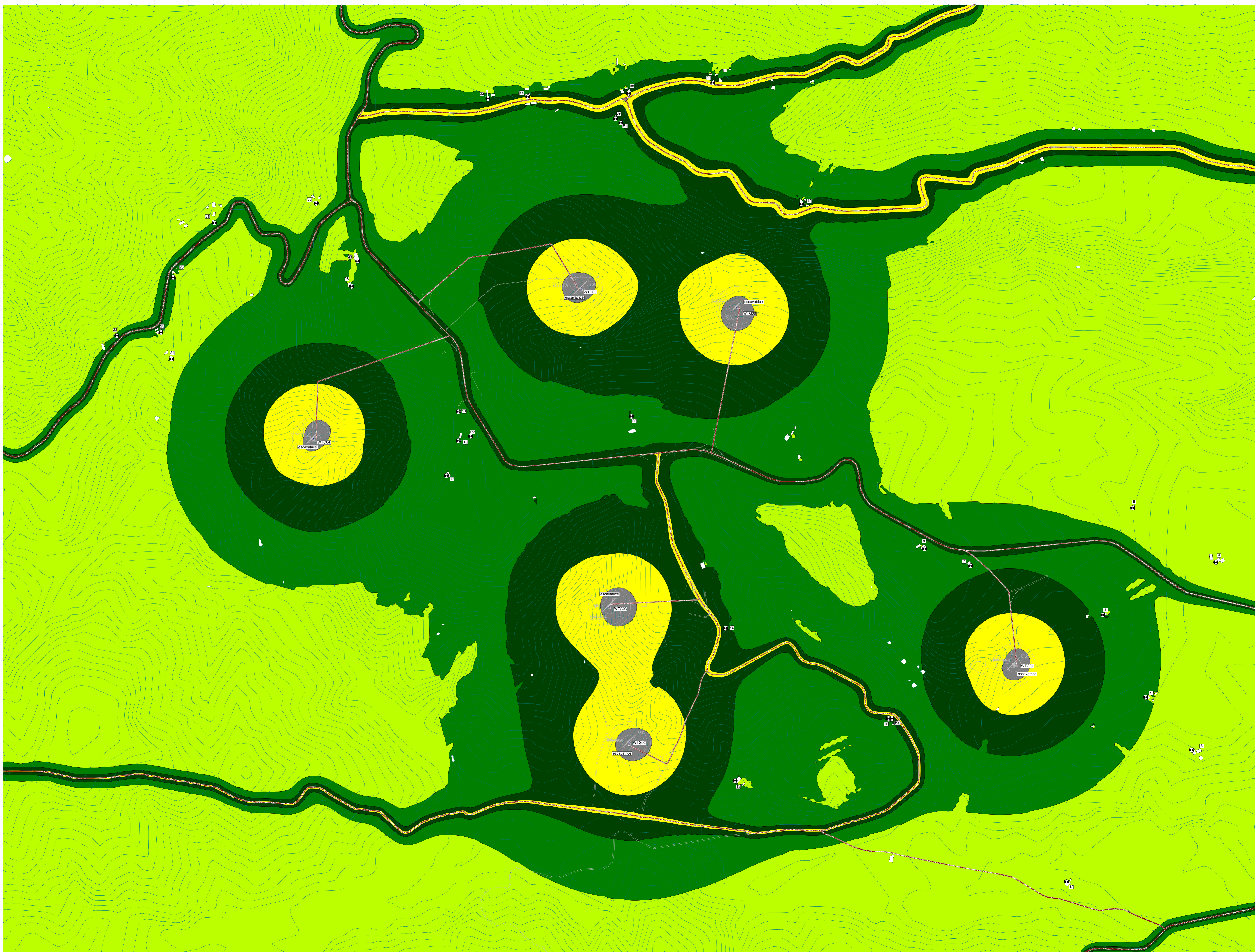
MAPPA A COLORI CON ISOFONICHE - LIVELLI DI IMMISSIONE NOTTURNI - FASE DI ESERCIZIO
